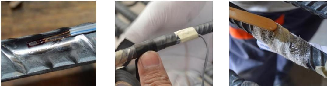
Figura A.1: a) Colocado del deformímetro b) Protección contra el agua c) Protección contra golpes
