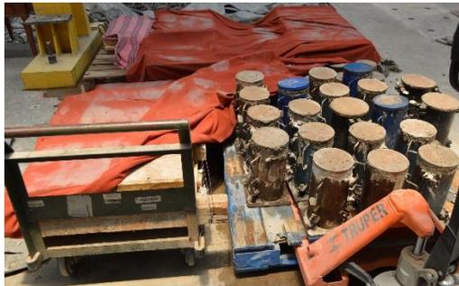
b) Curado de probetas con telas húmedas
