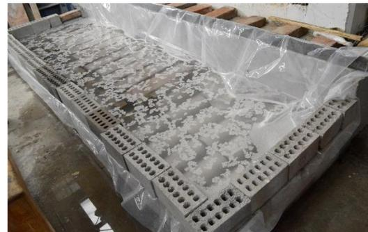
d) Curado de probetas.
