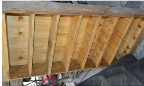
Figura A.3: Moldes de probetas prismáticas
