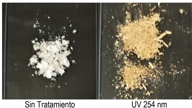
Figura 29. Comparación de la perovskita de (\text{NDA})_2\text{PbBr}_4 antes y después de irradiarlo
