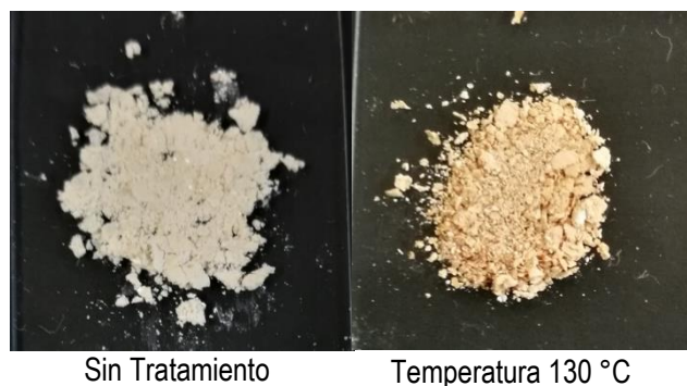
Figura 32. Comparación de la perovskita de [\text{NDA}]_2\text{PbCl}_4 antes y después de calentarlo
