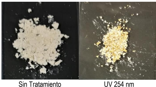
Figura 28. Comparación de la perovskita de [\text{NDA}]_2\text{PbCl}_4 antes y después de irradiarlo
