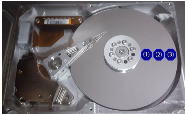
Figura 2-23. Zonas de medición del HDD
