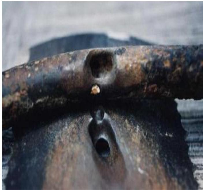
FIGURA 24. CORROSIÓN ENTRE LÍNEAS DE AGUA Y GASODUCTO DE LA EXPLOSIÓN EN GUADALAJARA JALISCO.
