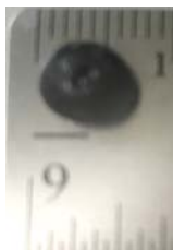
Figura 6.1: Fotografía de una muestra de HoCuBi - En la fotografía se muestra la forma, tamaño y color que tienen las muestras al salir del horno de arco.
