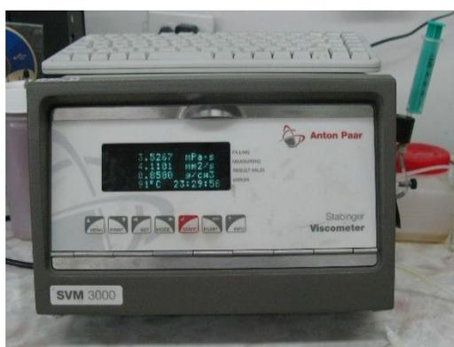
**Figura 11.** Viscosímetro Anton Paar Stabinger SVM 3000
