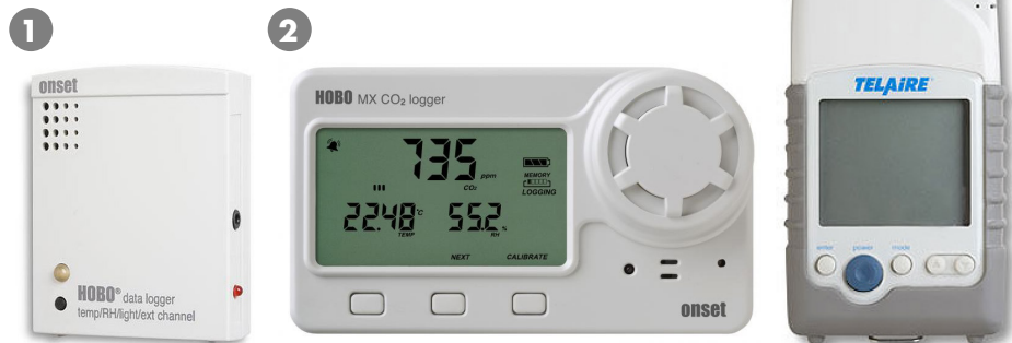
Imagen 42. Fotografías de los instrumentos utilizados en las mediciones ambientales, en las diferentes estaciones del año. 1. HOBO Data logger U12-012. 2. HOBO MX1102. 3. Telaire 7001.
