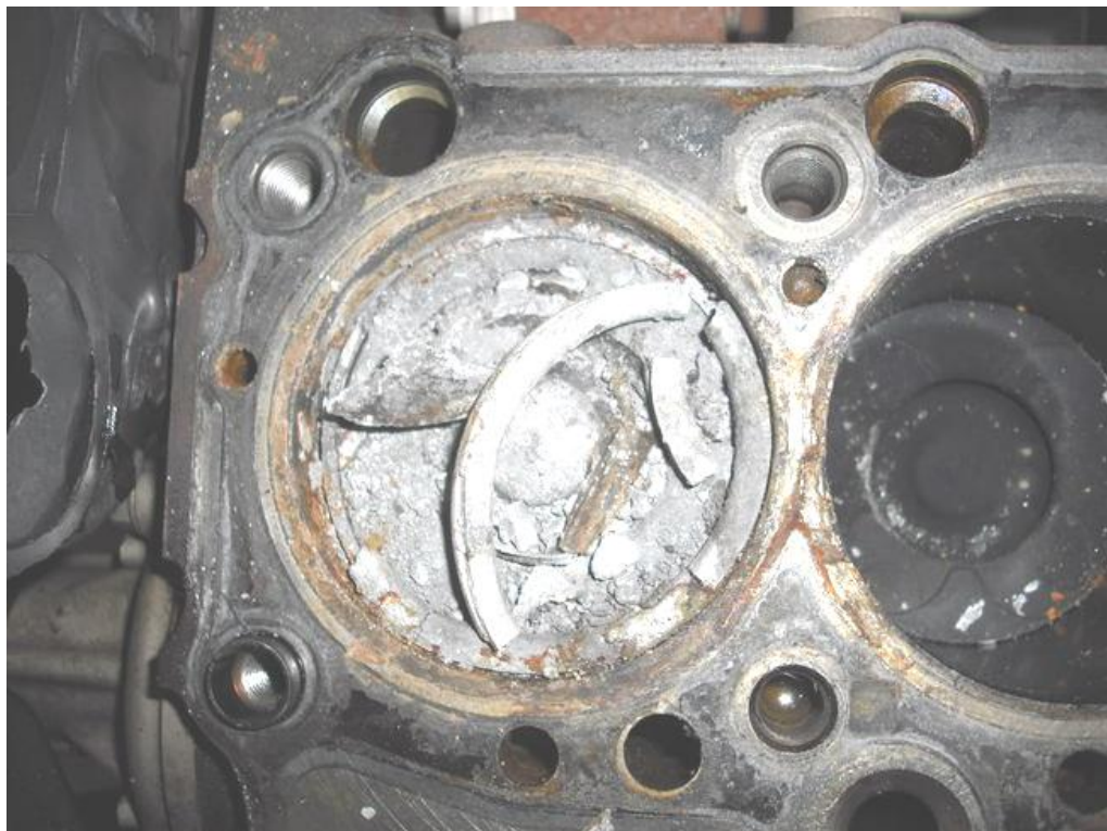
Fig. 2.2 Gripado pistón–camisa. (Referencia 10).
