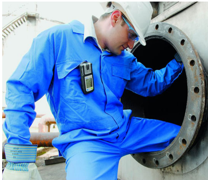
Figura 24. Uso de un detector de gases para el ingreso a una zona contaminada.
