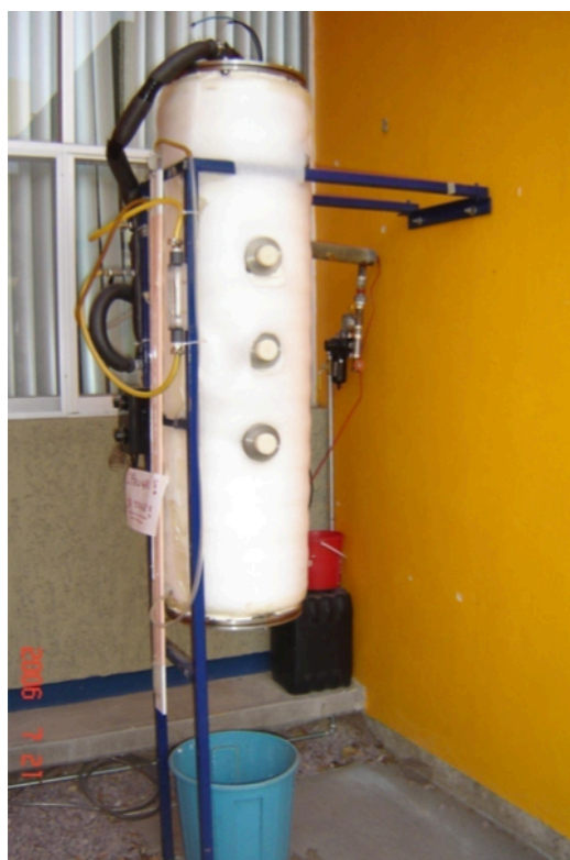
Figura 28. Configuración típica de un biofiltro de prueba. (Ramírez Piña, 2008)
