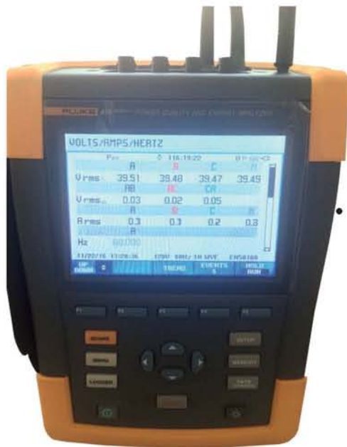
Conexión de corriente al analizador de energía Fluke 435
