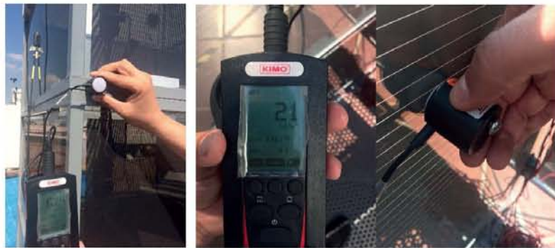
Ilustración 21. Izquierda, medición de irradiación en fachada sur. Centro y derecha medición al interior del vidrio sin transparencia.
