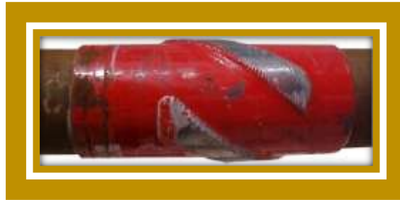
Figura 3.5. Estabilizadores de caras helicoidales necesarios en la perforación de pozos direccionales con tubería de revestimiento.
