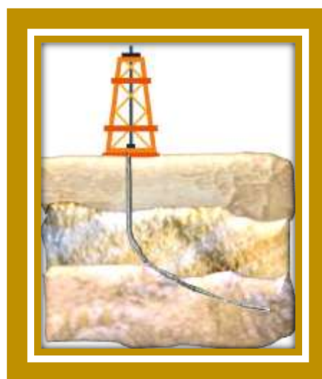
Figura 1.10. Pozo de construcción continua.
