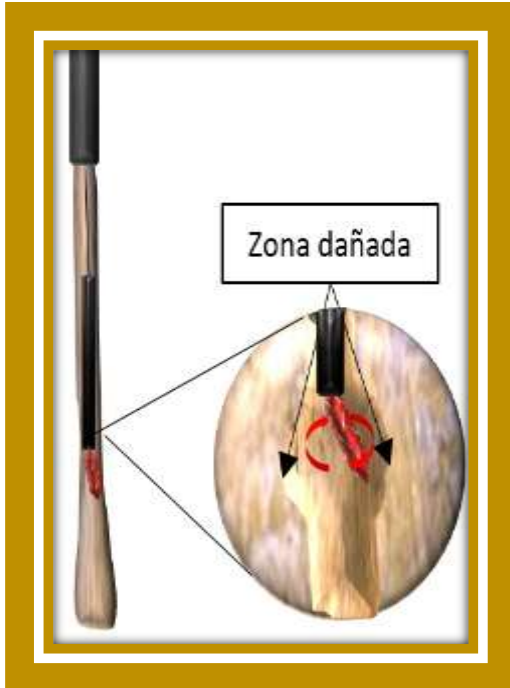
Figura 5.4. Daño causado a la formación por la herramienta localizadora durante la búsqueda de la ventana pre molida del lateral.
