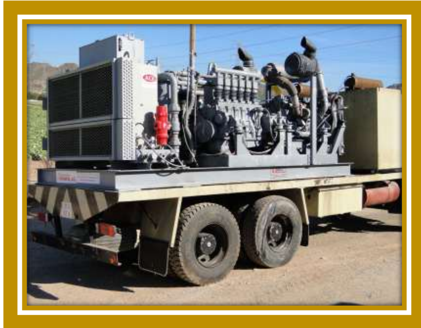
Figura 4.6. Equipo booster para una operación de perforación Bajo Balance. Tomada de " http://www.perforacionesromera.com/maquinaria-booster.php "
