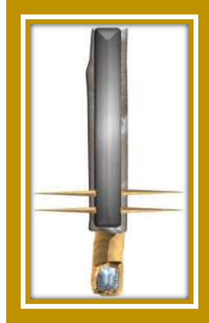
Figura 3.11. En la imagen, fue cementada la última sección de la perforación, el intervalo es disparado y puesto en producción mientras la barrena es dejada en el agujero.
