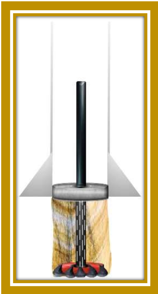
Figura 4.8. El uso de la conexión inflable dentro del intervalo a perforar permite el paso de equipo, en este caso el liner, para continuar con la operación aislando el intervalo y manteniendo control sobre el mismo.
