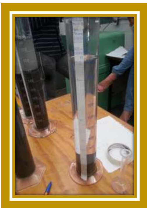
Figura 8.9, Prueba de sedimentación en un fluido de control, se observa la cantidad y la relación con respecto al tiempo con la cual se depositan las partículas sólidas.
