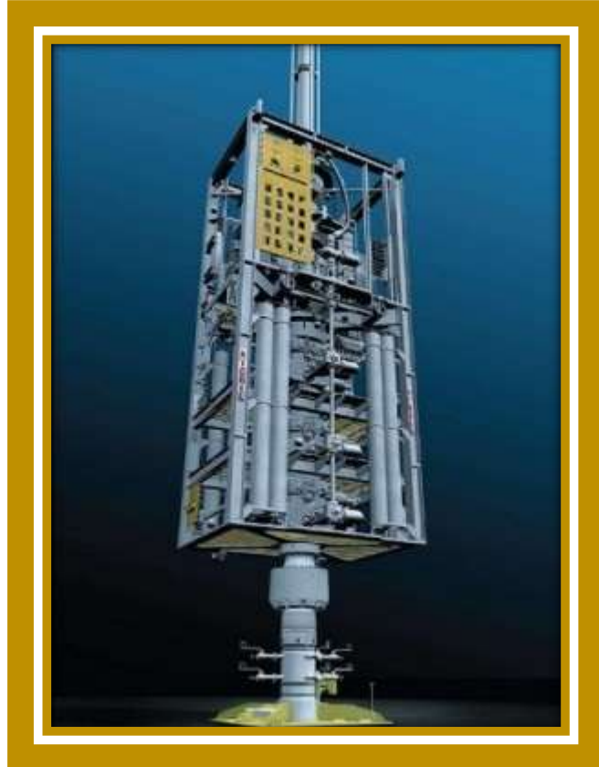
Figura 6.4. Blow-out Preventer submarino. Este es el arreglo de los preventores que son colocados sobre el lecho marino en el fondo del mar.
