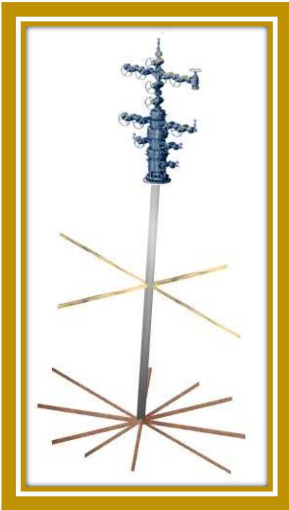
Figura 2.1. Perforación radial de dos intervalos diferentes con distinto número de laterales dispuestos radialmente.
