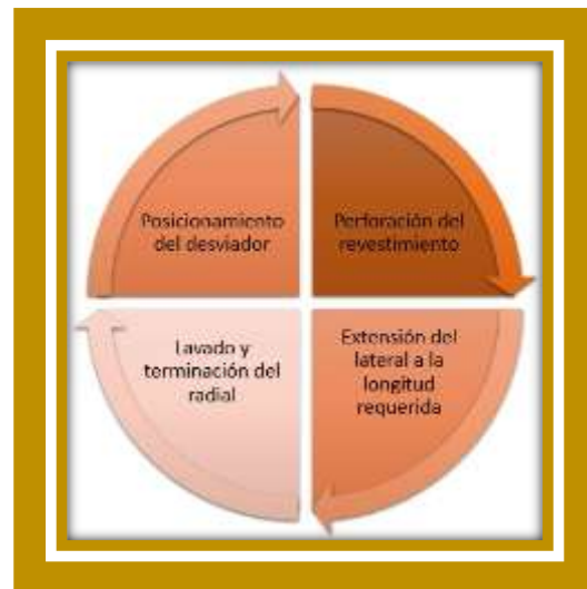
Figura 2.11. Metodología simplificada de la perforación radial bajo el método URRS.
