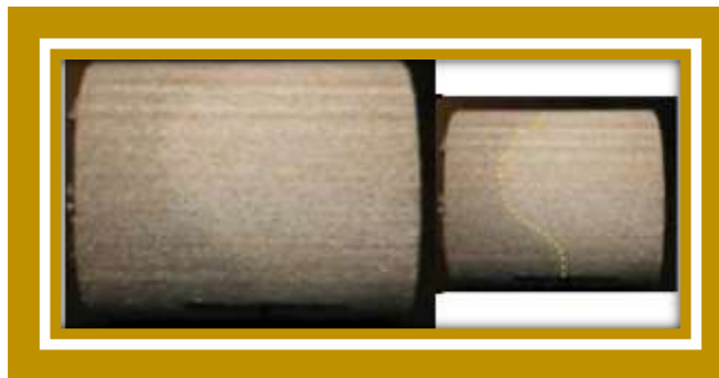
Figura 8.4. Las imágenes corresponden a una prueba de filtrado sobre un núcleo, la línea punteada amarilla en la sección pequeña de la imagen remarca el filtrado dentro de dicho núcleo. Tomada de “Desarrollo de un fluido de alto rendimiento a base aceite para perforación exploratoria”. Faergstad, Irene.
