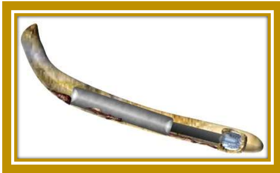
Figura 7.9. La perforación direccional de pozos altamente desviados puede provocar la acumulación de recortes dentro del agujero comprometiendo la limpieza del mismo y aumentando los riesgos de pegaduras y colapsos.
