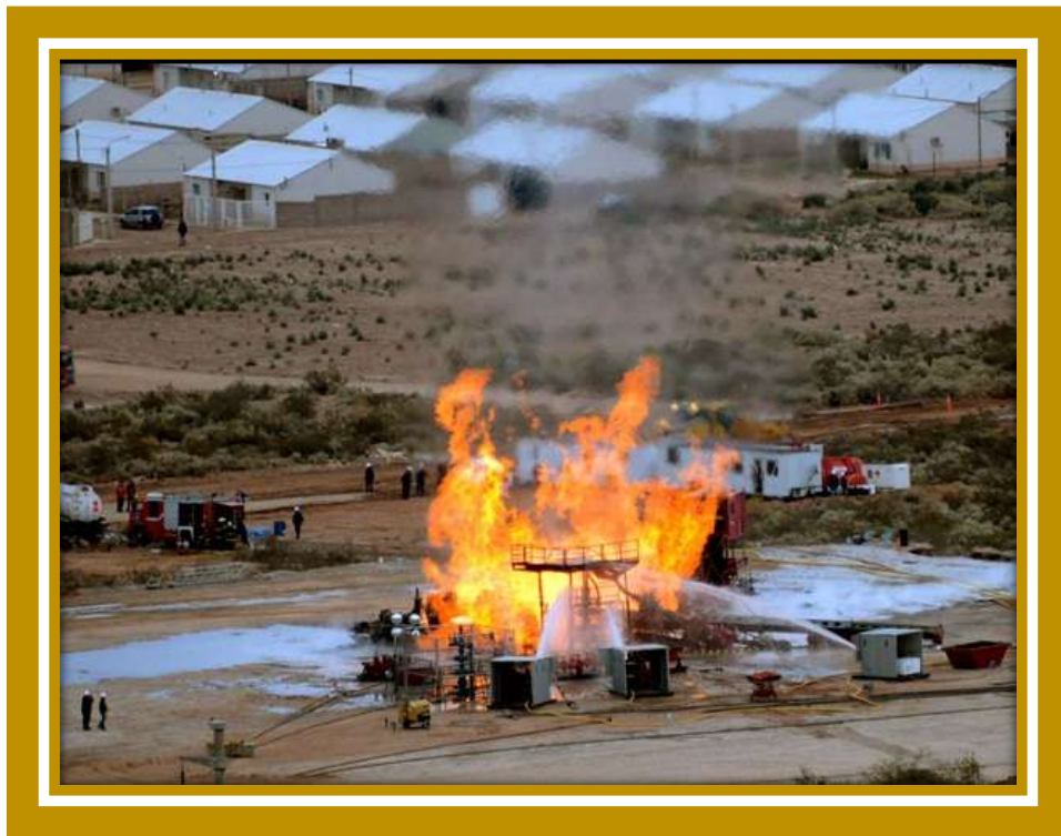
Figura 8.1. Explosión en un pozo petrolero derivada del pobre manejo de fluidos provenientes de la formación. Tomada de http://redproteger.com.ar .
