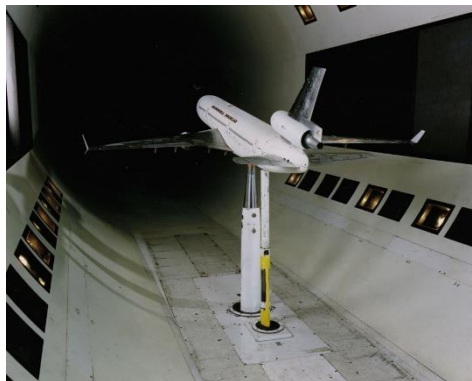
Figura 91. Pruebas físicas en un túnel de viento (Great bustard's flight, 2016).
