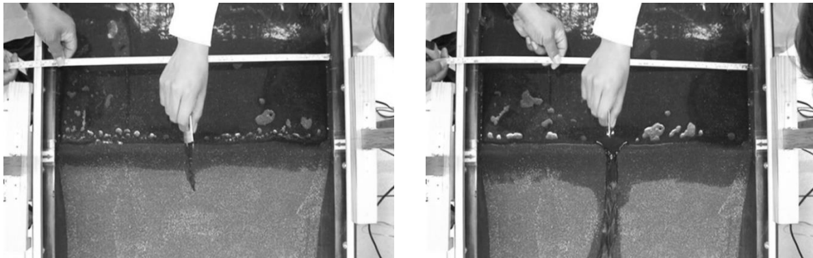
Ilustración 3.5 Llenado del embalse e inicio de falla
