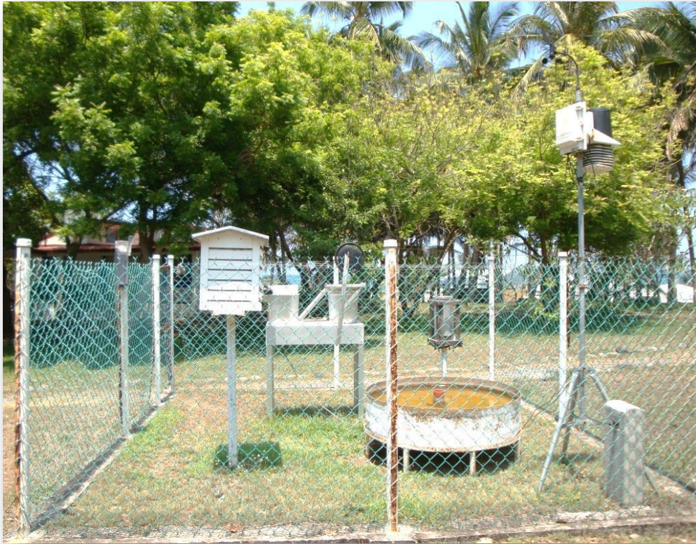
Figura 3.3 Estación meteorológica automática y colector automático de depósito atmosférico, de la SCA-CCA-UNAM, en el CICOLMA.
