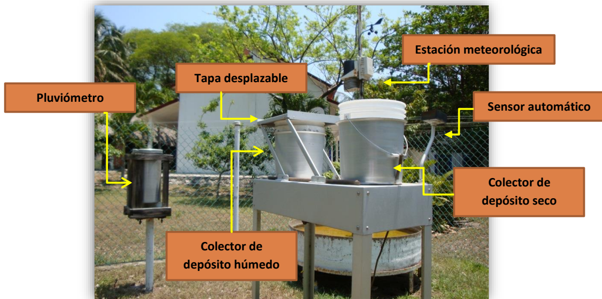
Figura 4.3 Estación meteorológica automática y colector automático marca Aerochem Metrics Inc. Mod.301 para depósito atmosférico en el CICOLMA, La Mancha – Veracruz.
