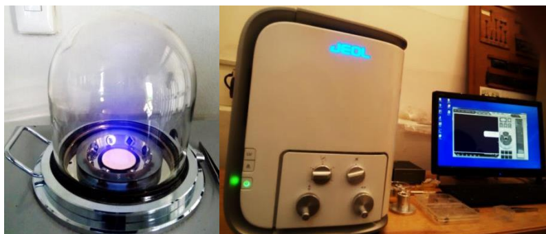
Figura 7. Procesamiento de muestras para MEB. Equipo de pulverización iónica de capa fina en proceso (izquierda) y MEB(derecha).
