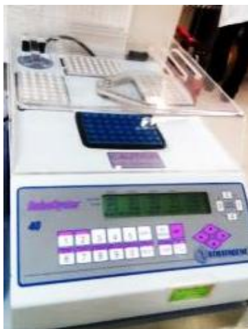
Figura 9. Retrotranscripción de RNA. La imagen muestra el termociclador empleado para retrotranscribir el RNA aislado para obtener cDNA.
