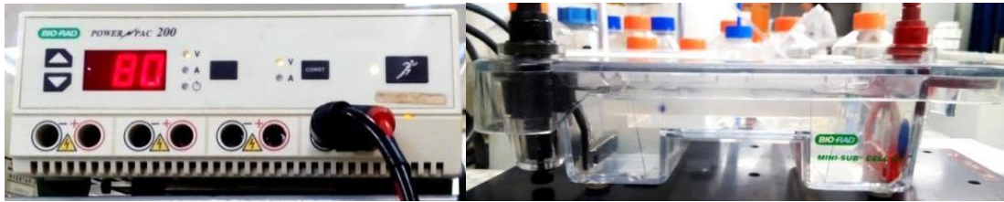
Figura 12. Equipo de electroforesis con muestra en proceso. En la izquierda está la fuente de potencial eléctrico y en la derecha se muestra la cámara de electroforesis.
