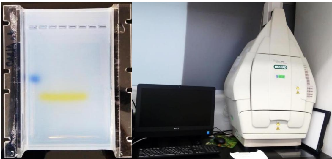
Figura 13. Proceso para revelar geles de electroforesis. Del lado izquierdo se observa el gel que se va a revelar y del lado derecho el equipo fotodocumentador.
