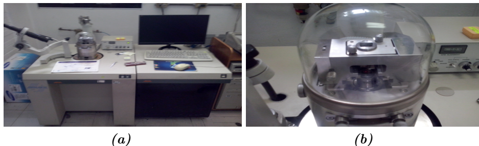
Figura 2.7: Arreglo experimental para medir la Morfología (Microscopio de fuerza atómica).
