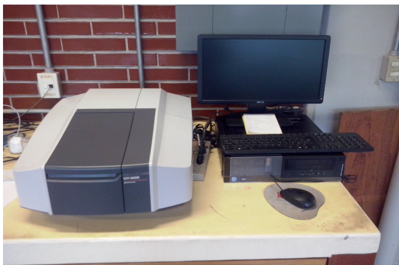
Figura 3.6: Arreglo experimental para medir la Transmitancia..
