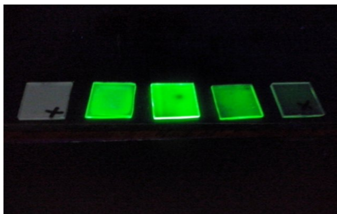
Figura 5.34: Películas de Zn_2SiO_4 : Mn . De izquierda a derecha: 0, 2.5, 5, 7.5 y 10 % at. Excitadas con lámpara de UV (254 nm)..
