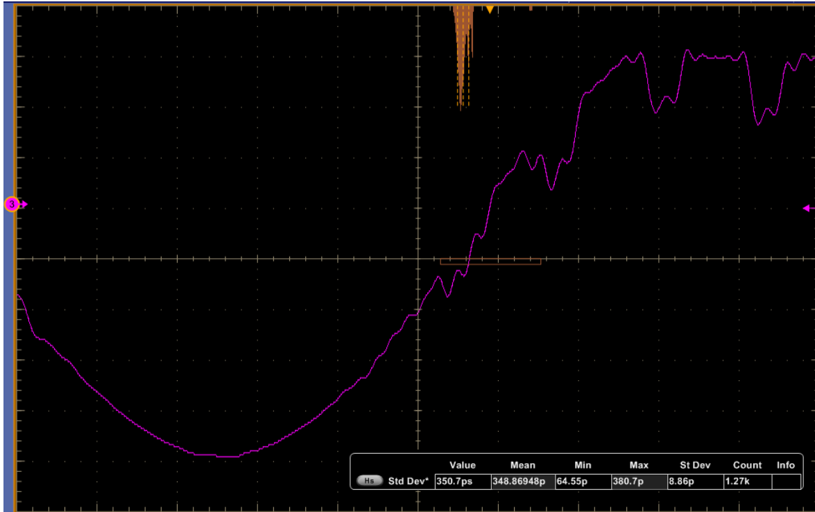
Figura 5.25: Medición del jitter de apertura de la señal de reloj del convertidor A/D.
