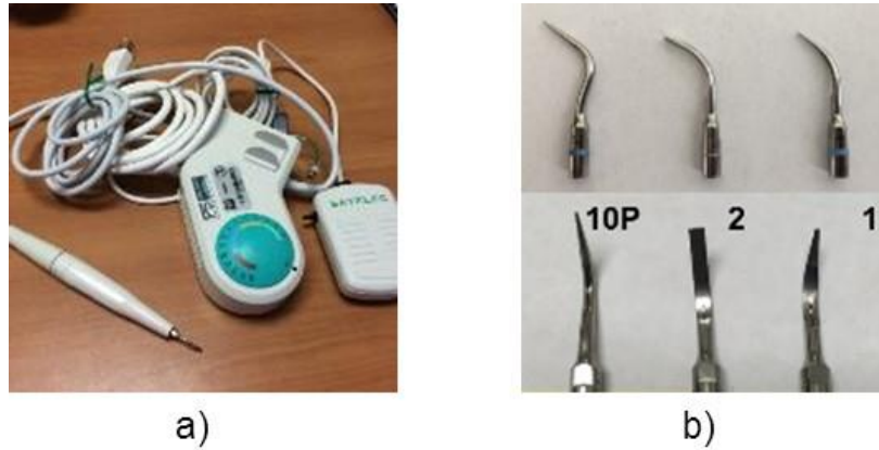
Figura 10. Sistema de limpieza ultrasónica, scaler Booster P5 , Satelec ®. a) Sistema de limpieza ultrasónica; b) puntas de limpieza; 10P, 2 y 1.
