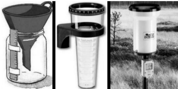
*Ilustración 1 Pluviógrafo*
