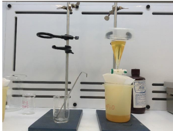
Fig. 3.1 Embudo de separación con MEI para la separación de minerales pesados. Taller de Separación Mineral (CGeo).
