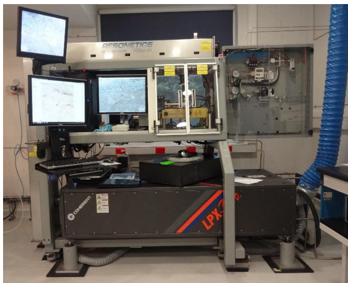
Fig. 3.4 Sistema de ablación láser excímero de 193 nm de la marca Resonetics, modelo Resolution. M-50. LEI, CGeo.
