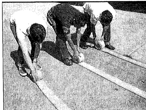
Foto 6. Enrollado de la manguera en la modalidad de almacenamiento
