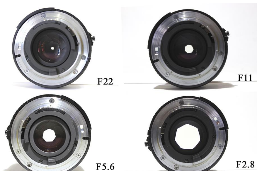
Figura 28. Apertura de diafragma. Elaboración Propia
