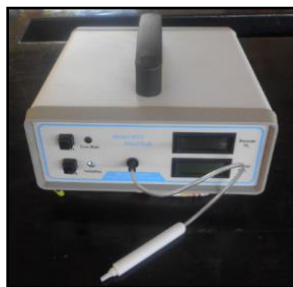
Figura 27. Analizador de gases.
