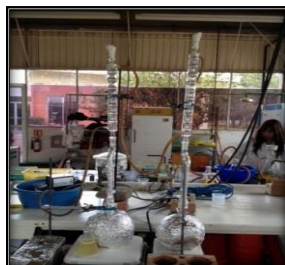
Figura 8. Hidrodestilación de aceites esenciales
