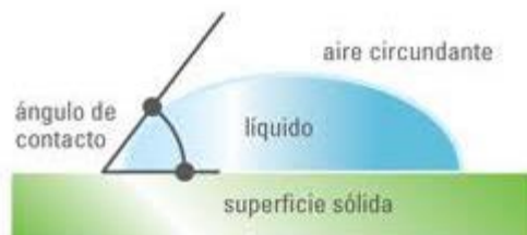
Fig. 29. Ángulo de contacto.
