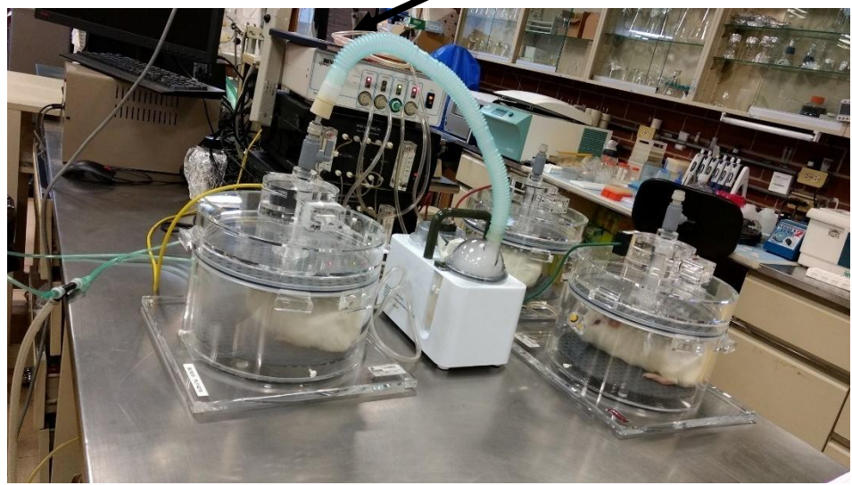
Figura 4. Foto del equipo de pletismografía barométrica. El equipo funciona para medir la respuesta obstructiva y la función pulmonar de los cobayos.
