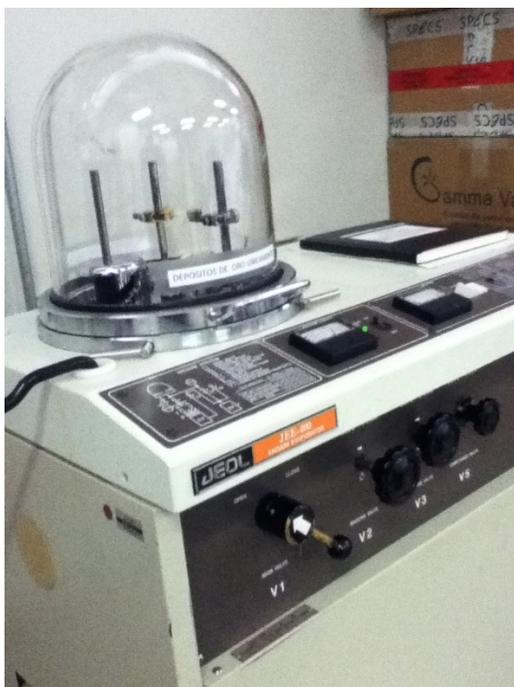
**Figura 16.** Evaporadora para depositar electrodos de oro
