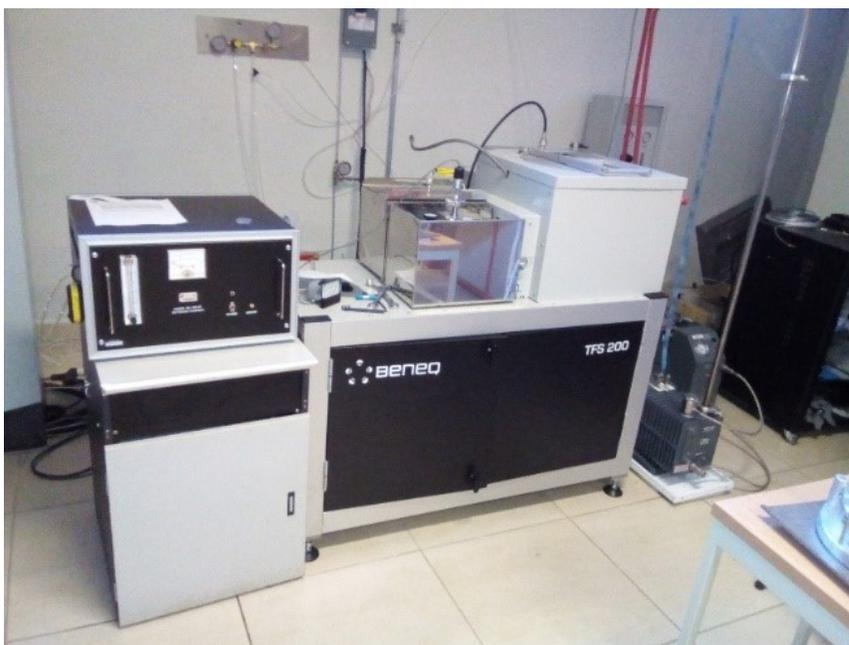
**Figura 11.** Equipo para depósitos ALD.
