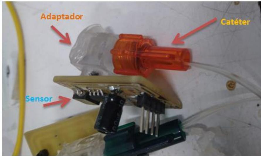
Figura 65. Acoplamiento entre el catéter y el sensor.
