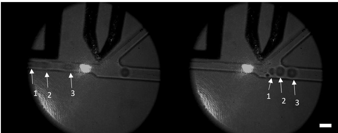
Figura 5.21 Espaciamiento irregular en la reinyección de las micro-gotas. Barra de escala de 45 [μm]
