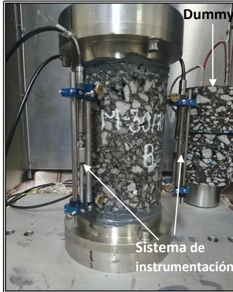
**Figura 5.71. Montaje y acondicionamiento del espécimen de prueba.**
