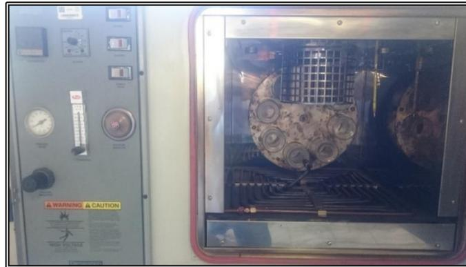
**Figura 5.9. Equipo para envejecimiento a corto plazo, RTFO (ASTM D2872).**
