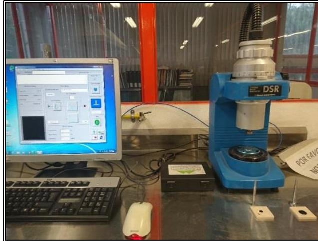
Figura 5.5. Reómetro de corte dinámico y software para la adquisición de datos (ASTM D4402).
