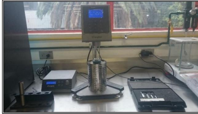
**Figura 5.3. Viscosímetro rotacional para determinar la viscosidad dinámica a 135° C (ASTM D4402).**
