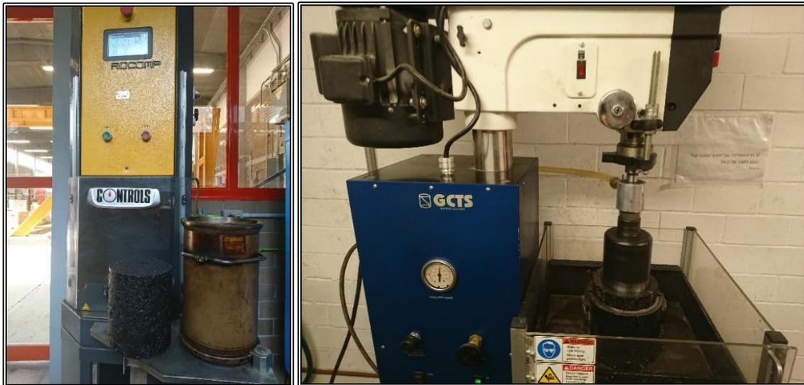
**Figura 5.70. Elaboración de especímenes en el compactador giratorio (izquierda) y extracción de núcleos para obtener las dimensiones de probetas establecidas en la norma AASHTO T342 (derecha).**
