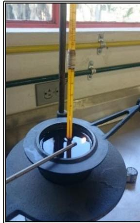
Figura 5.2. Ensayo de punto de inflamación Cleveland (ASTM D92).
