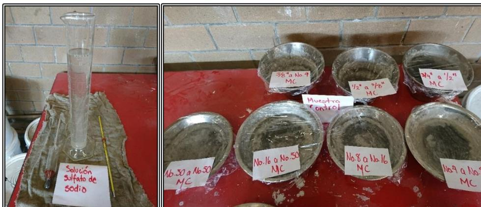
**Figura 5.41. Preparación de la solución de sulfato de sodio (izquierda) y ciclo de inmersión y secado de las muestras de agregado en sus diferentes fracciones (derecha).**
