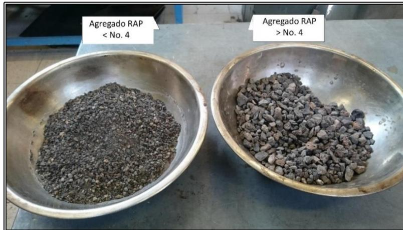
**Figura 5.35. Agregado RAP recuperado por el método de incineración.**
