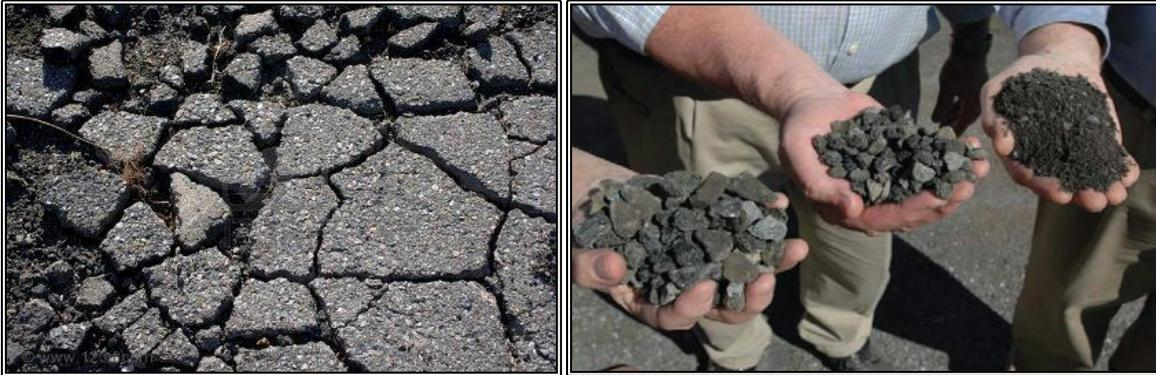
**Figura 2.1.** Vista de una carpeta asfáltica triturada (izquierda) para posteriormente ser procesada y almacenada en fracciones de RAP (derecha).
