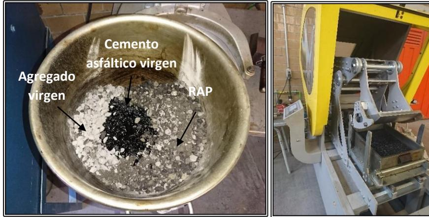
**Figura 5.61. Proceso de mezclado de la mezcla asfáltica con RAP (izquierda) y compactador de rodillo liso conforme a la norma EN 12697-33 (derecha).**
