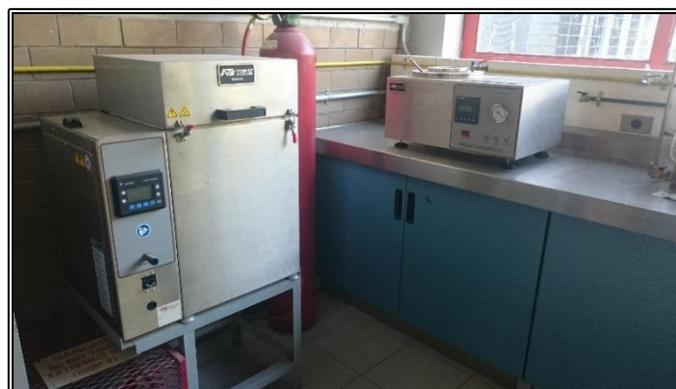
**Figura 5.10. Equipo para elaborar el ensayo de envejecimiento a largo plazo, PAV (ASTM D6521).**
