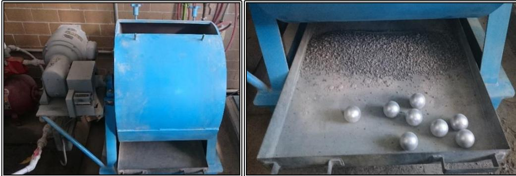
**Figura 5.40. Máquina de desgaste los Ángeles (izquierda) y material triturado con 8 esferas después de 500 ciclos (derecha).**
