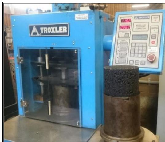
**Figura 5.45. Compactador giratorio Troxler utilizado en la compactación de mezclas asfálticas.**
