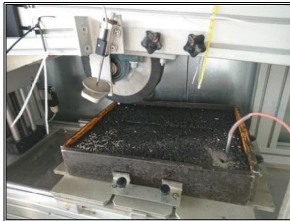
**Figura 5.62. Ensayo de pista de rueda española de acuerdo con la norma EN 12697-22 (Dispositivo pequeño - Procedimiento B en aire).**
