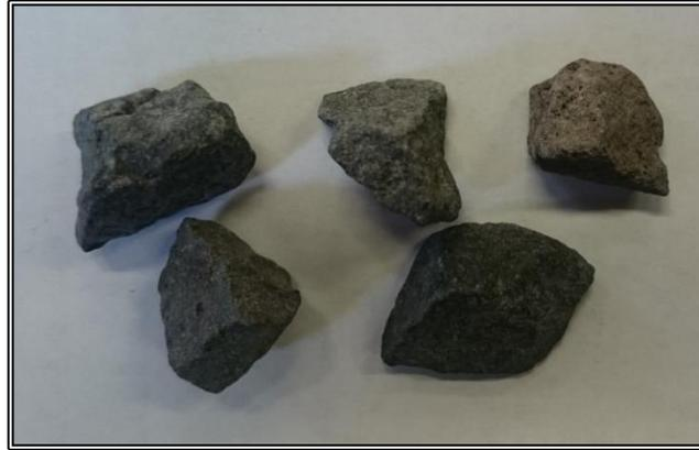
**Figura 5.36. Vista de partículas retenidas por la malla del No. 4 que presentan más de dos caras fracturadas.**
