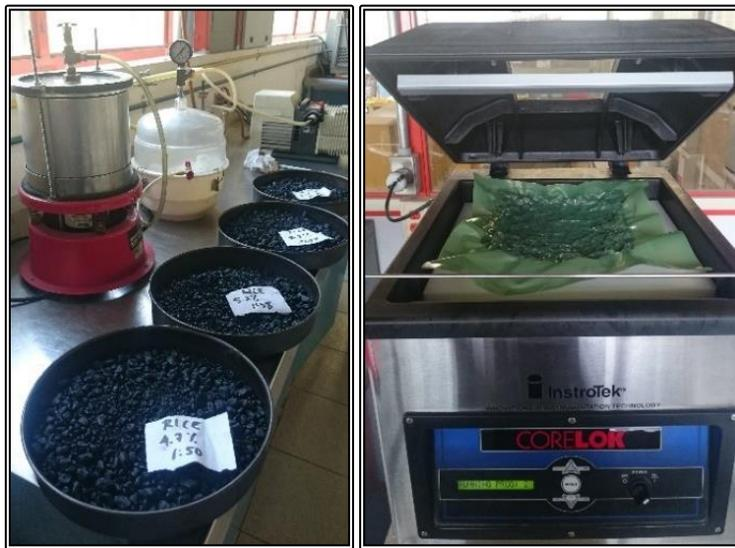
**Figura 5.47. Determinación de la densidad relativa teórica máxima mediante método de picnómetro (izquierda) y con CoreLok (derecha).**
