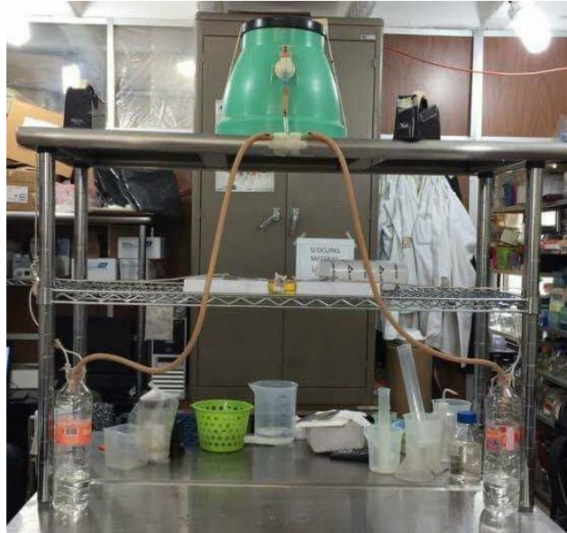
Figura 29. Sistema utilizado para la evaluación de la fuerza de cierre, mediante el método tensiométrico.
