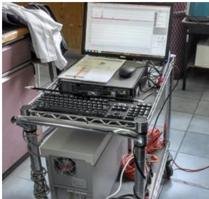
Imagen 39. Espectrómetro de Masas con sistema de muestro por sonda con succión de 20 mL de gas / min.
