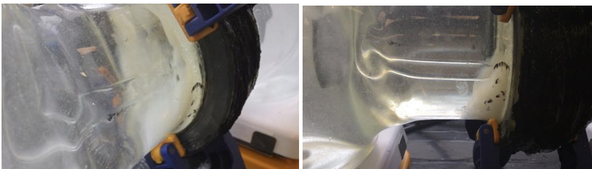
Imagen 43. Vista del diafragma contaminado con 300 mg/L de Mg^{2+} al interior de la celda (izquierda) y vista de lado (derecha).
