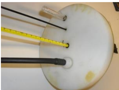
Imagen 27. Dos vistas de la colocación de los instrumentos, en la tapa del compartimiento anódico, para el análisis de gases, medición de temperatura, electrodo anódico y puente de Luggin para medir la diferencia de potencial.
