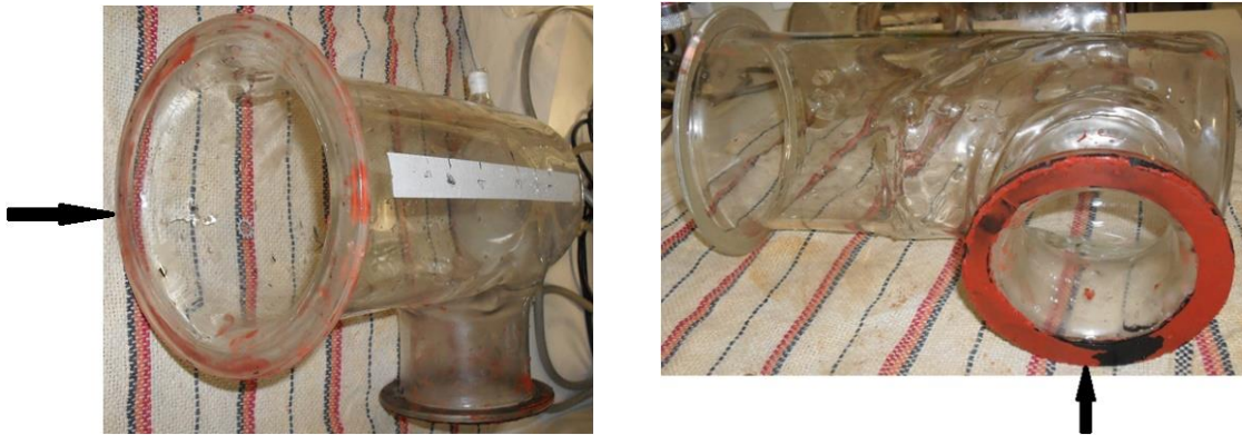
Imagen 22. Parte superior de la semi-celda (izquierda), unión de diafragma (derecha).
