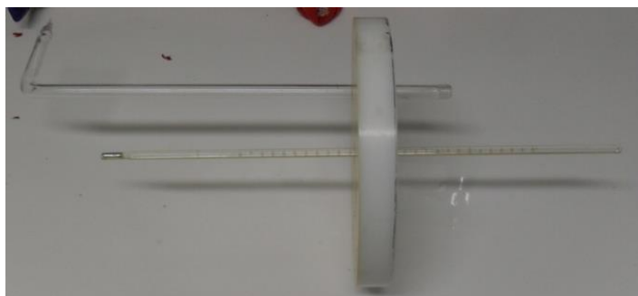
Imagen 28. Colocación de los instrumentos, en la tapa del compartimiento catódico, para medición de temperatura y puente de Luggin para medir la diferencia de potencial.
