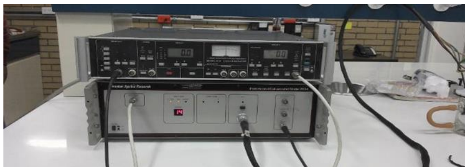
Imagen 38. Amplificador marca Princeton Applied Research (PAR) modelo 5210 de 0.5 Hz a 120 kHz.
