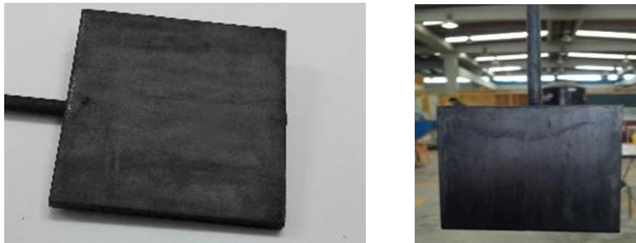
Imagen 11. Ánodos dimensionalmente estables, hechos de titanio con recubrimiento de TiO 2 +RuO 2 .
