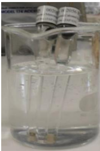
Imagen 17. Electrodo de referencia atornillados en la parte superior de los puentes de Luggin.
