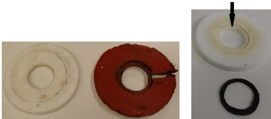
Imagen 23. Soportes derecho e izquierdo del diafragma donde son colocados empaques de neopreno de 1 mm de espesor, (izquierda). Soportes del diafragma junto con el adhesivo base silicón (derecha).
