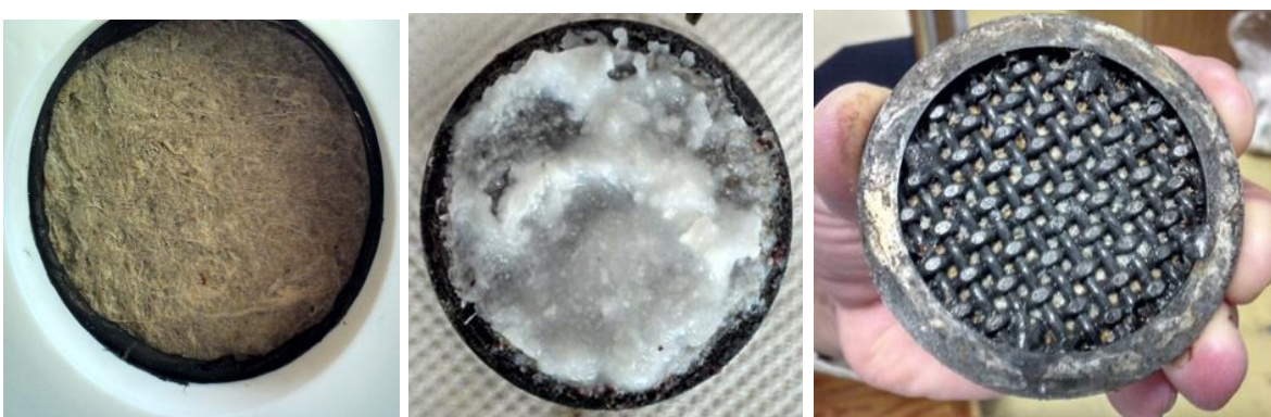
Imagen 44. Diafragma en el estado inicial y final de la corrida experimental contaminado con iones Mg^{2+} por el lado del diafragma que se dirige al ánodo (imagen izquierda y central) y por el lado de la malla catódica (imagen derecha).
