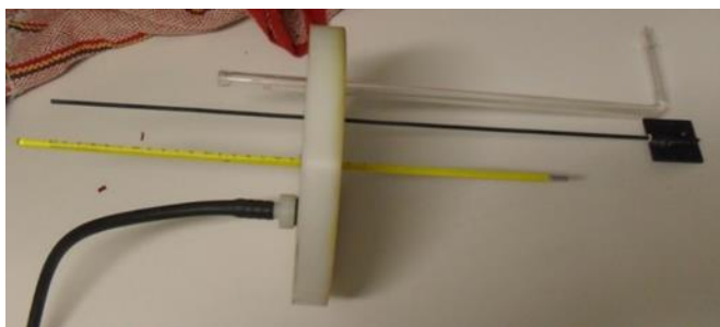
Imagen 27. Dos vistas de la colocación de los instrumentos, en la tapa del compartimiento anódico, para el análisis de gases, medición de temperatura, electrodo anódico y puente de Luggin para medir la diferencia de potencial.
