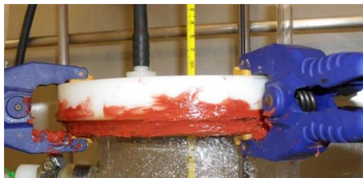
Imagen 30. Sellado de las tapas de la semi-celda.
