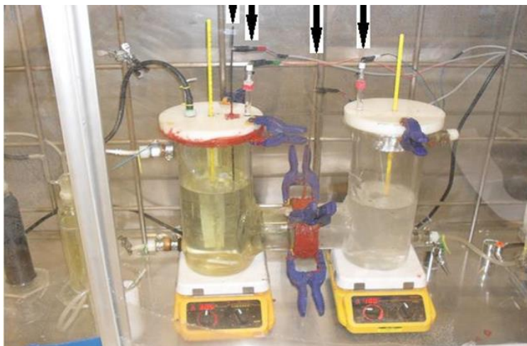
Imagen 32. Celda electrolítica para la producción de cloro- sosa, puesta en operación junto con las conexiones eléctricas.
