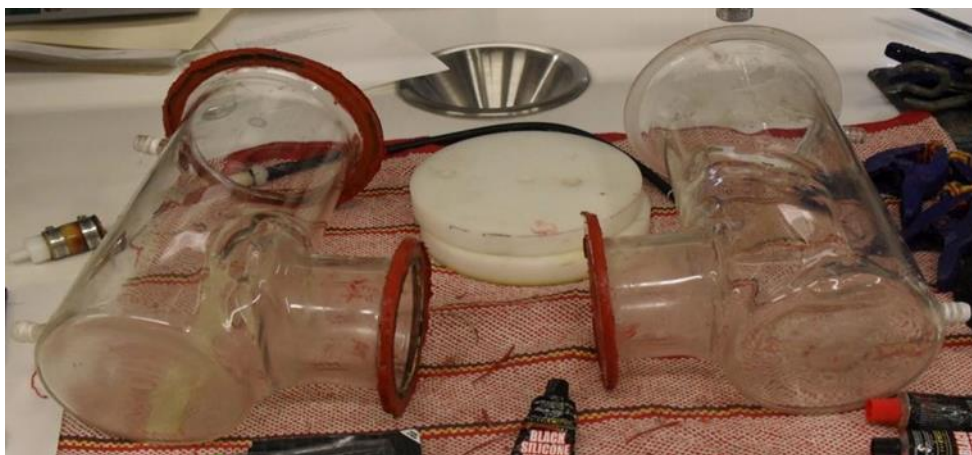
Imagen 12. Dos medias celdas de vidrio Pyrex® con 4 mm de espesor.
