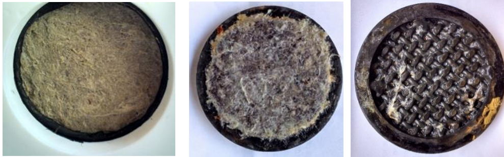
Imagen 41. Diafragma antes de la adición del contaminante (izquierda) Vista de las dos caras del diafragma de asbesto en el estado final de la corrida experimental contaminado con 300 mg/L de iones \text{Ca}^{2+} (medio y derecha).
