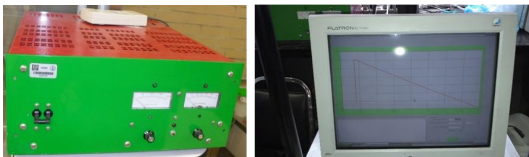
Imagen 33. Potenciostato/Galvanostato con tarjeta de adquisición de datos conectado a un programa de adquisición de datos para técnicas electroquímicas en una computadora.
