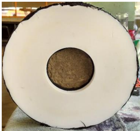
Imagen 21. Soporte de diafragma junto con empaques y diafragma en el interior antes de ser colocado en el centro de las celdas.
