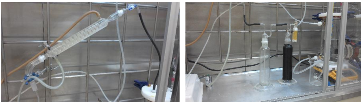
Imagen 35. Sistema de enfriamiento de gases (izquierda) y trampa de condensados, trampa de H_2SO_4 y trampa de sílica gel para separar el HCl y secar el gas cloro (derecha).
