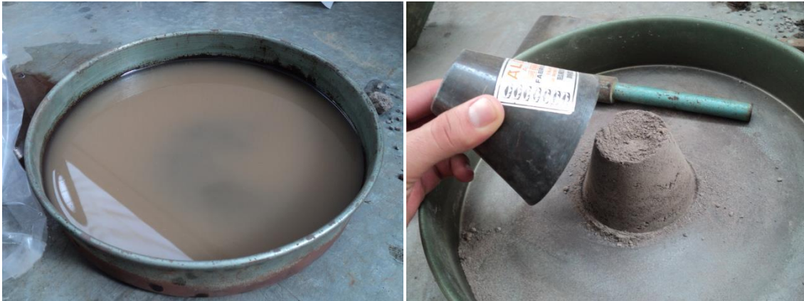
Foto 3.1. Saturación por 24 horas y prueba del troncocónico.
