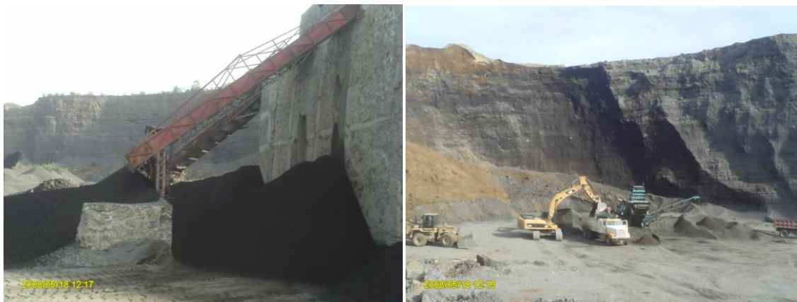
Foto 4.9. Mallas grandes para cribado y selección de agregado (izquierda), y pared del talud donde se aprovechan los agregados volcánicos (derecha); todo en el banco de materiales de Paracho
