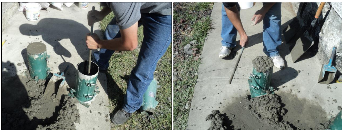
Foto 3.7. Varillado en molde para cilindros y vibrado para expulsar burbujas.
