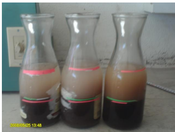
Foto 3.3. Prueba para conocer nivel material fino en una arena
