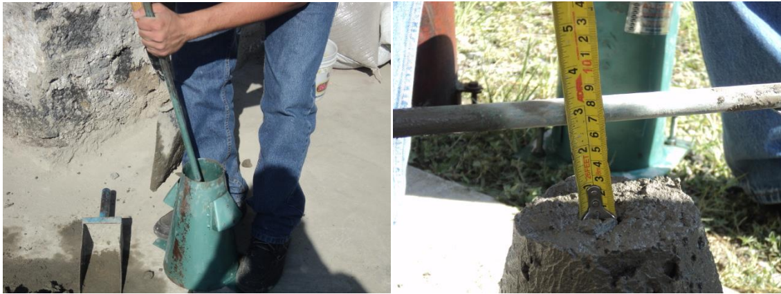
Foto 3.6. Molde para la prueba de revenimiento y medición de revenimiento
