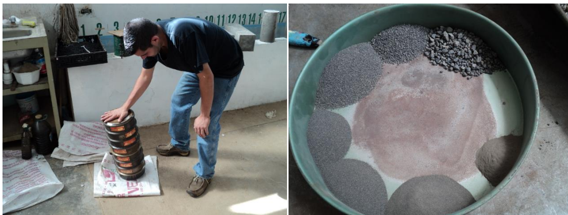
Foto 3.2. Agitado del material y materiales retenidos después de ser pesados
