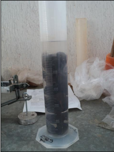
Foto 3.4. Densidad en gravas. Grava volcánica dentro de la probeta graduada.
