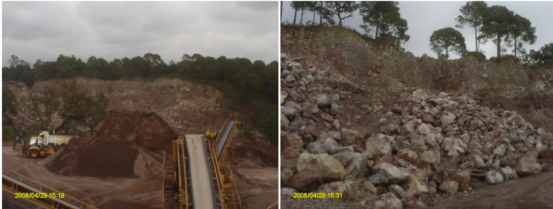
Foto 4.8. Bandas transportadoras para selección de agregados (izquierda), y roca madre de la cual se obtiene el agregado triturado (derecha); todo en el banco de materiales 2.
