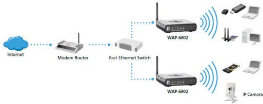
Imagen 71. Función del access point en la red
