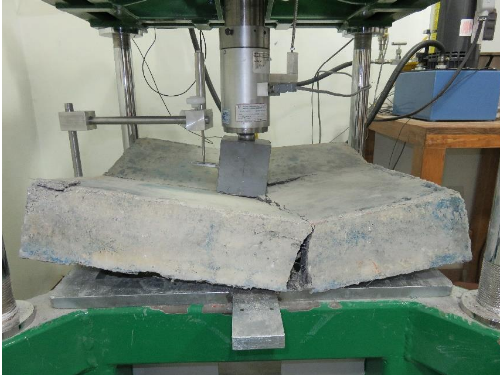
Figura 64. Falla de un panel en una prueba real de laboratorio. Cortesía Laboratorio Consultec-Geosa (2017).
