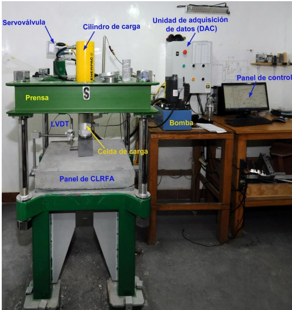
Figura 58. Fotografía de la implementación del ensayo de capacidad de absorción de energía. Laboratorio Consultec-Geosa.
