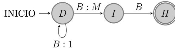
**Figura 3.5:** Máquina para la medición de la longitud, avanza en la mínima escala de la regla y pregunta una por una si la magnitud es menor que el valor de la cuenta.
