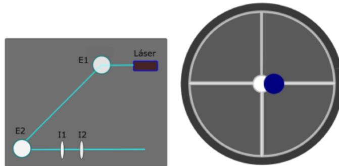
**Figura 3.7:** Figura tomada de [Mar17] a la que se refiere el texto citado. Se muestra un haz desalineado.
