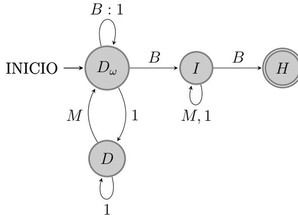
**Figura 3.3:** Máquina para colocar los valores dictados por el oráculo en la cinta. Éste permite la introducción de varios argumentos como cadenas del símbolo ‘1’, cada cadena está separada por el marcador ‘M’. Nótese que en el estado inicial tenemos dos condiciones de respuesta para el espacio blanco, se utiliza una u otra dependiendo de la respuesta del oráculo.
