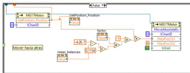
**Figura 3.10:** Programa en LabView para movimiento de motor [Mar17]
