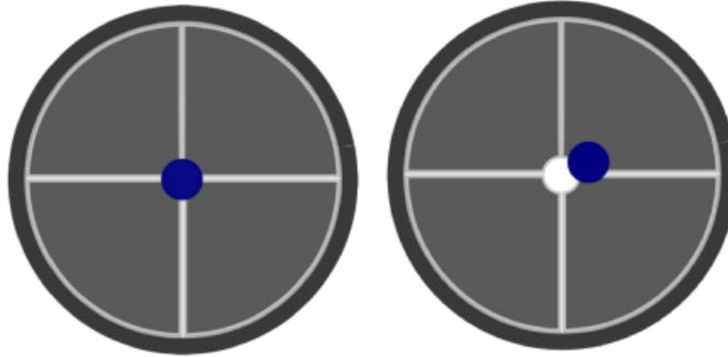
**Figura 3.8:** Figura tomada de [Mar17]. Corresponde a la figura 8 del texto citado. Muestra un haz desalineado.
