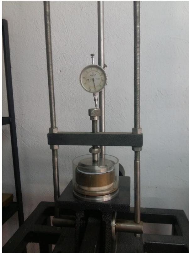
Fotografía 5.5. Colocación de la prueba en el consolidómetro.
