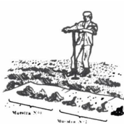
Imagen 1.14. Muestras individuales mediante perforaciones con barrena.
