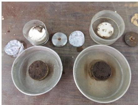
Fotografía 5.14. Pruebas desmontadas de los consolidómetro.
