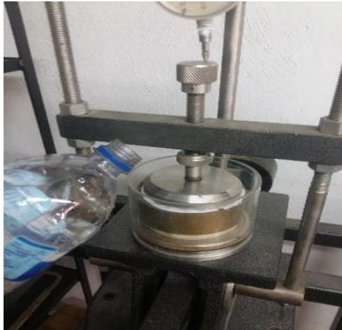
Fotografía 5.7. Colocación de agua para saturar la prueba.
