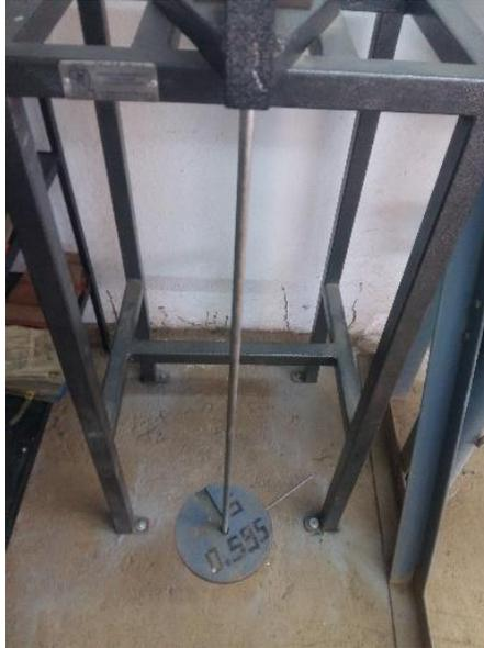
Fotografía 5.6. Primera carga con las pesas del consolidómetro.
