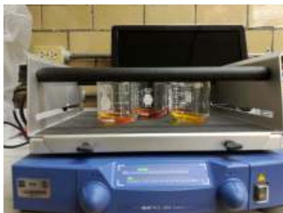
Figura 3.4. Montaje del sistema de agitación con la optomembrana de CTA – TEHP – PAN.
