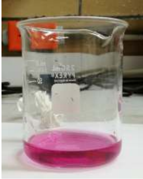
Figura 4.25. Imagen de la lixiviación del complejo de CuPAN + de la película polimérica.
