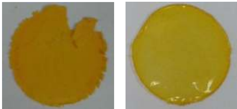
Figura 4.2. Optomembrana de CAB – TEHP – PAN opaca (izq.) y optomembrana de CTA – TEHP – PAN translúcida (der.).
