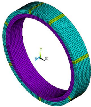
Modelado tridimensional de avances de excavación mediante enfilajes de micropilotes autoperforantes.
