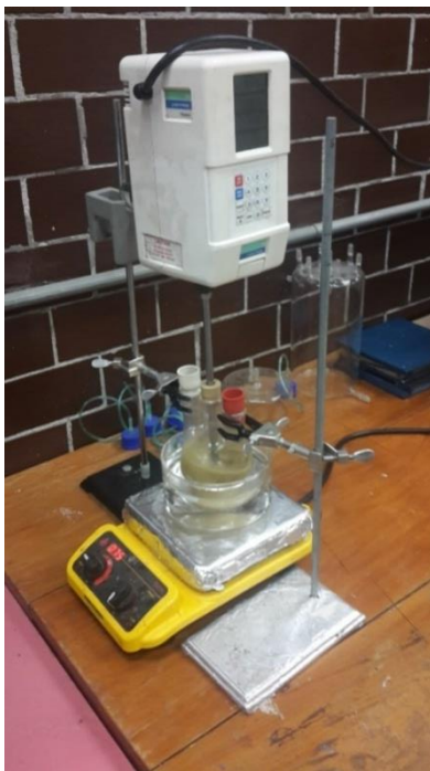
Figura 10. Reactor de vidrio adaptado a una parrilla de calentamiento con un agitador mecánico.
