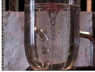
Figura 2.1: Vórtice de Rankine al vaciar contenedor, imagen tomada en el Laboratorio de Fluidos de la Facultad de Ciencias de la UNAM.
