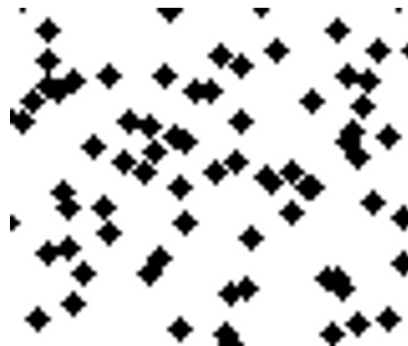
Figura 3.1: Sección de 65 \times 65 pixeles del patrón de puntos aleatorios pegado al fondo del tanque.
