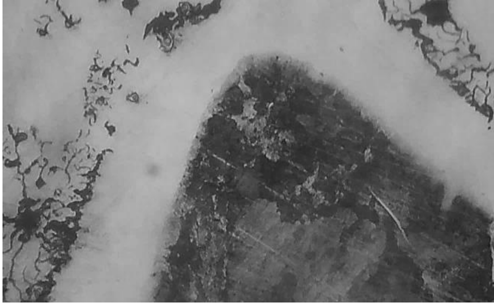
FIGURA 30. Microestructura de un hierro fundido gris a 600X.
