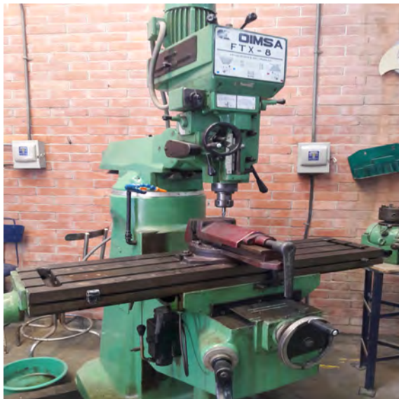
Figura 10. A cada una de las piezas obtenidas se les dio un refrentado en una fresadora marca Dimsa figura.
