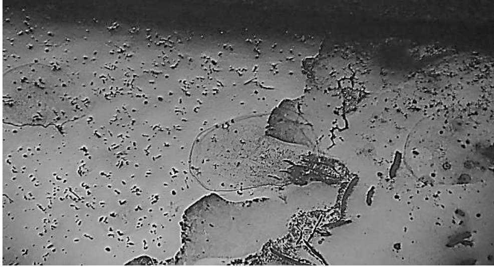
FIGURA 19. Microestructura de un hierro fundido gris a 50X.
