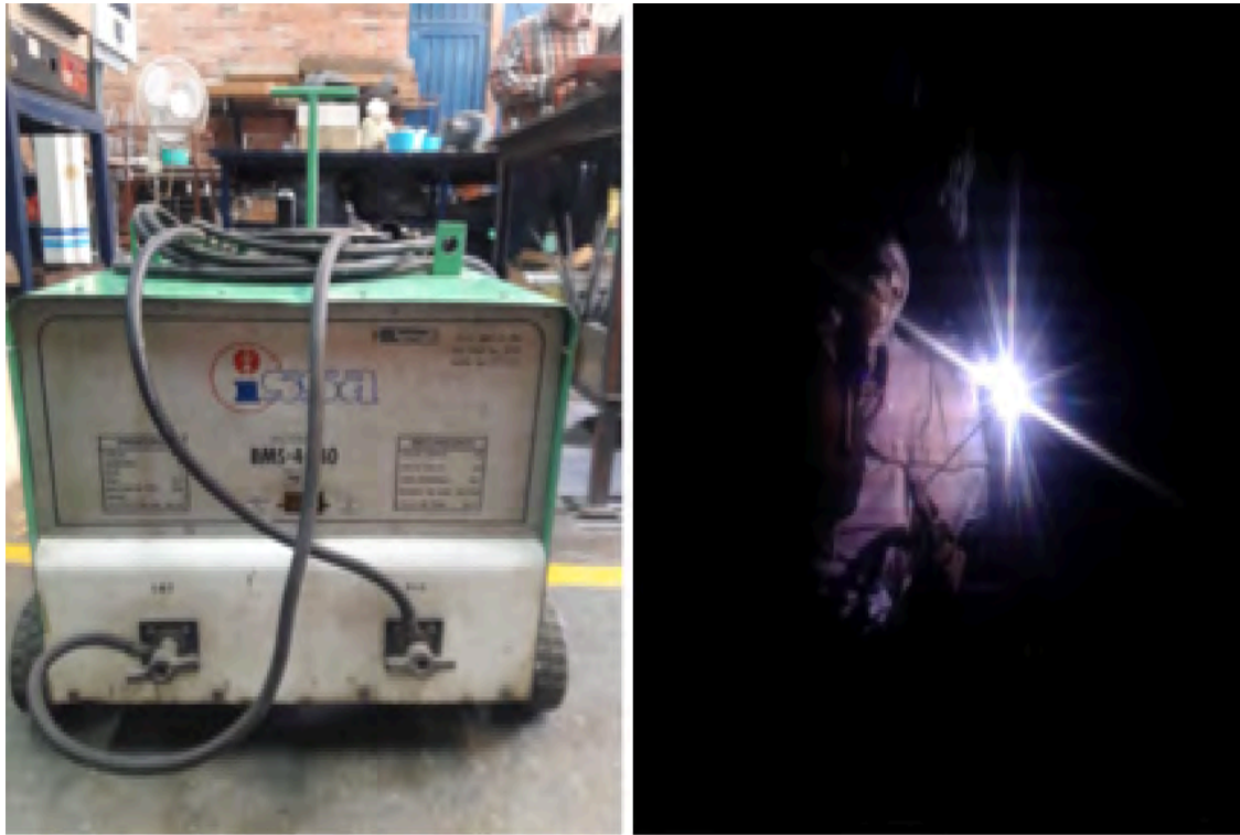
Figura 8. Maquina soldadora ISSA y realización del cordón de soldadura.
