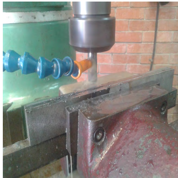
Figura 10. A cada una de las piezas obtenidas se les dio un refrentado en una fresadora marca Dimsa figura.
