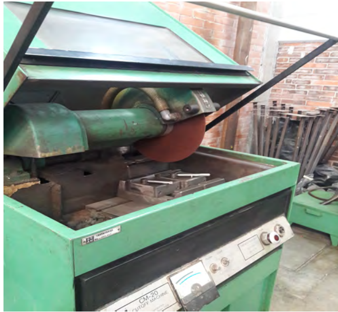
Figura 9. Corte de placas para probetas de tensión
