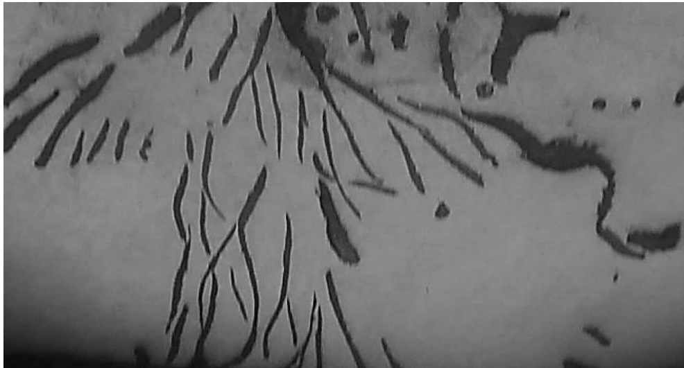
FIGURA 23. Morfología de la estructura de un hierro fundido gris a 100X.
