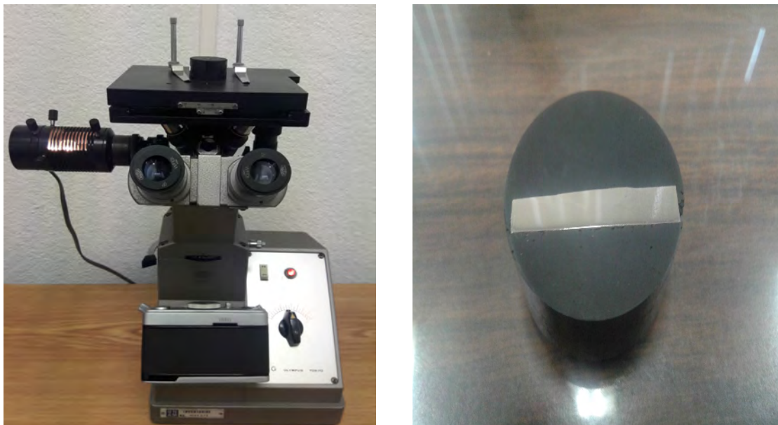
Figura 14. Microscopio óptico y probeta montada en baquelita.
