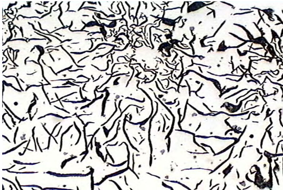
Figura 2. Microestructura de la fundición gris, 100X.
