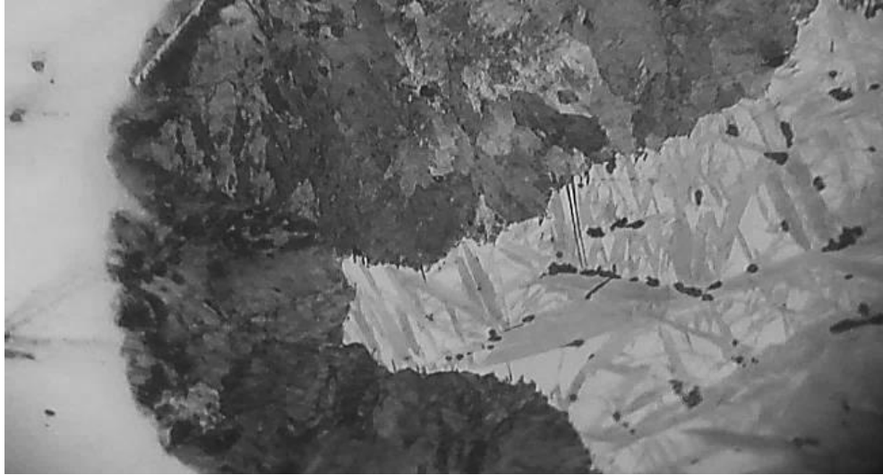
FIGURA 24. Microestructura de un hierro fundido gris a 400X.
