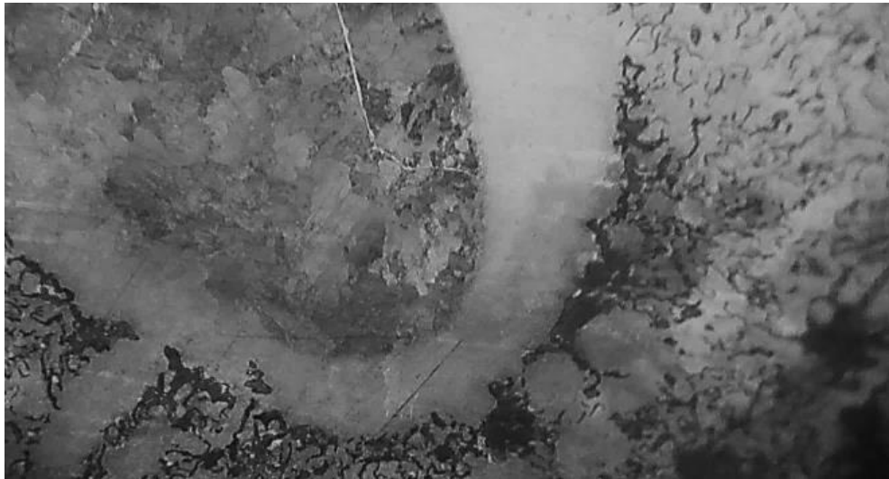
FIGURA 25. Microestructura de un hierro fundido gris a 400X.
