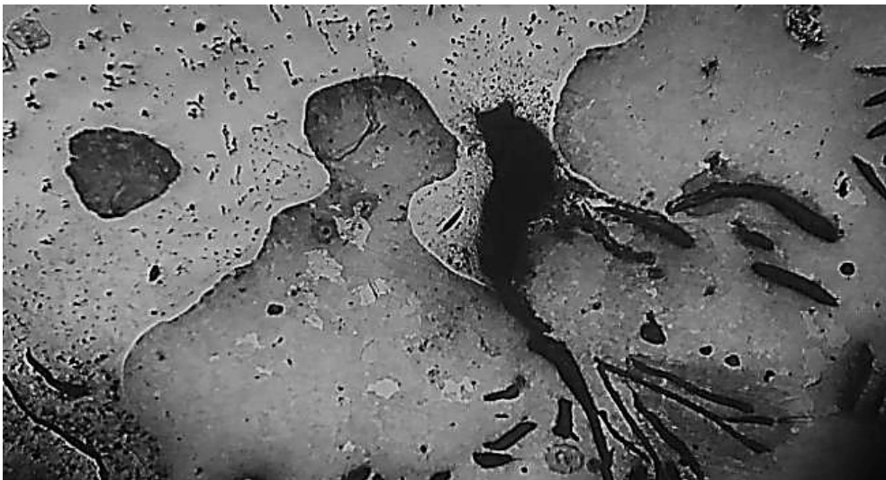
FIGURA 18. Microestructura de un hierro fundido gris a 50X.
