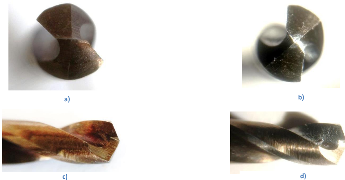
Figura 4-24 Imágenes de la broca de 4.6 mm (3/16 in) antes y después de ser utilizada. a) Vista superior antes de ser usada. b) Vista superior después de las perforaciones. c) Vista lateral antes de ser utilizada. d) Vista lateral después de ser utilizada
