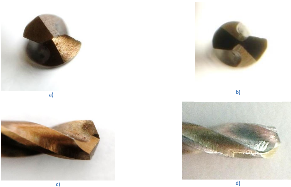
Figura 4-22 Imágenes de la broca de 3 mm (1/8 in) antes y después de ser utilizada. a) Vista superior antes de ser usada. b) Vista superior después de las perforaciones. c) Vista lateral antes de ser utilizada. d) Vista lateral después de ser utilizada
