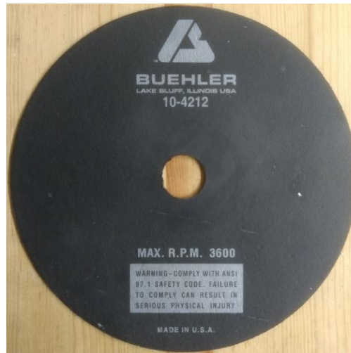
Figura 3-8 Disco de corte utilizado durante la preparación de las probetas
