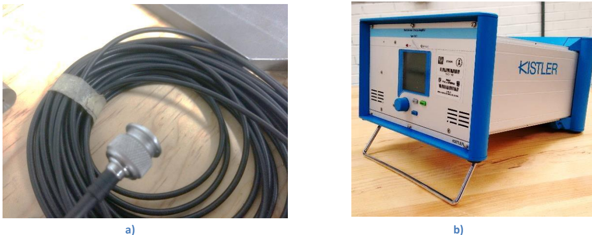
Figura 3-13 a) cable blindado para transmisión de señales, b) amplificador de señal (Udiatem, Análisis Experimental de los Procesos con Arranque de Viruta, 2016)
