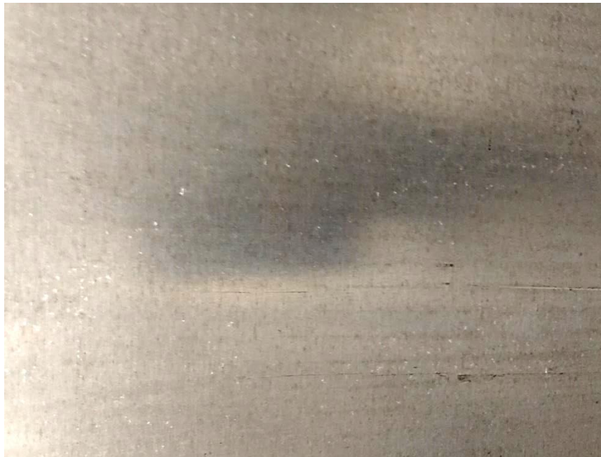
Figura 3-1 Líneas de laminación en placa trabajada
