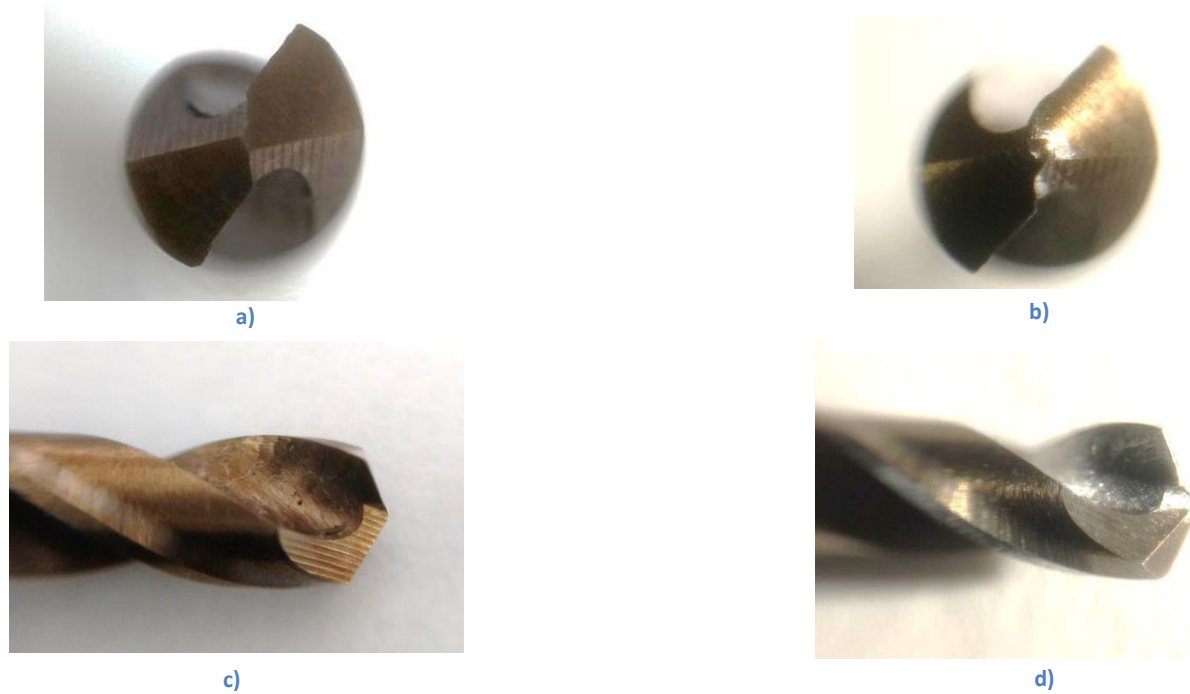
Figura 4-23 Imágenes de la broca de 3.82 mm (5/32 in) antes y después de ser utilizada. a) Vista superior antes de ser usada. b) Vista superior después de las perforaciones. c) Vista lateral antes de ser utilizada. d) Vista lateral después de ser utilizada
