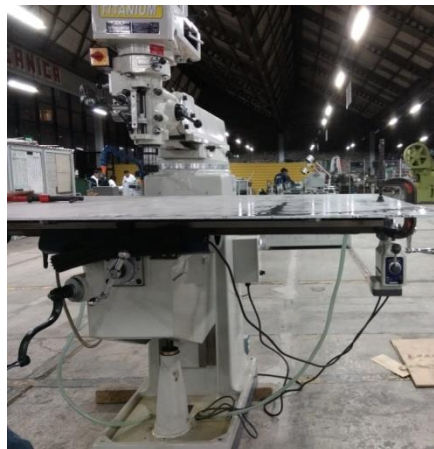
Figura 3-3 Montaje de la placa para realizar el primer corte en la fresadora
