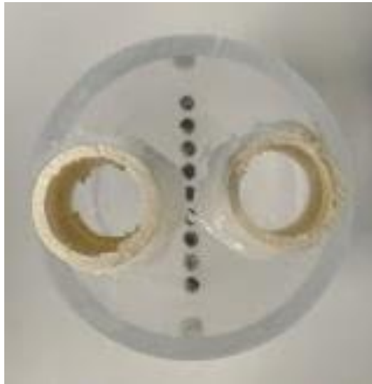
Ilustración 67 Vista frontal ensamble por adhesión.
