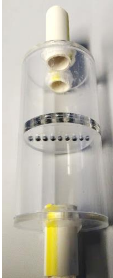
Ilustración 63 Perpendicularidad entre micro canales y alimentadores.
