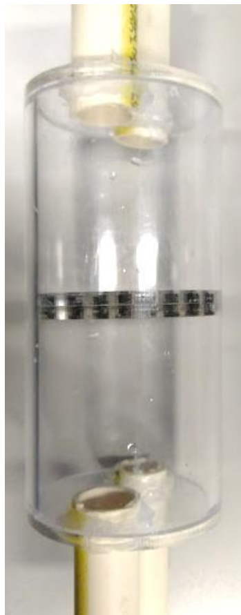
Ilustración 66 Vista lateral ensamble por adhesión.
