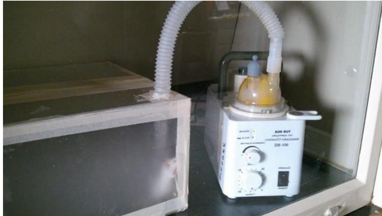
Figura 11. Cámara de acrílico y nebulizador empleados para las exposiciones
