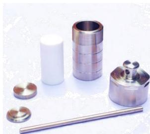
Figura 18. Autoclave para síntesis hidrotermal.
