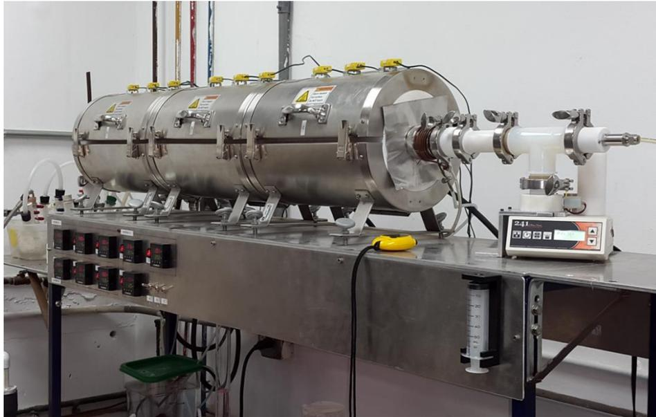
Imagen 1. Equipo experimental para la síntesis de spray pirolisis
