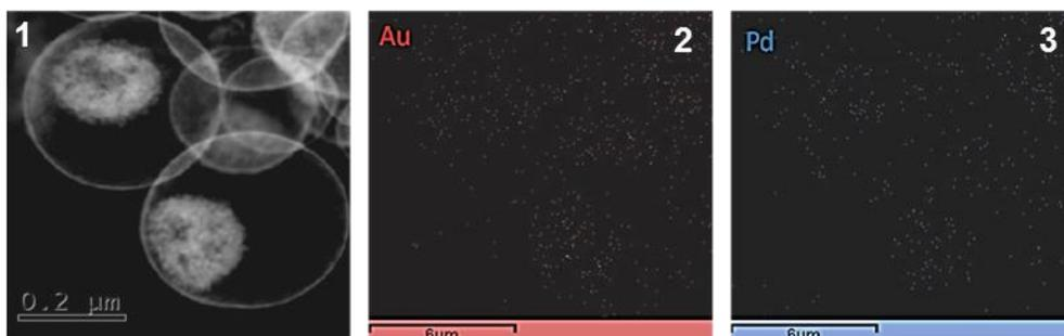
Figura 68. La imagen de STEM en campo oscuro representa la zona de análisis de nanorreactores con núcleo bimetalico Au-Pd (1), acompañada por los mapas resultantes de Au (2) y de Pd (3) obtenidos por la técnica EDX.
