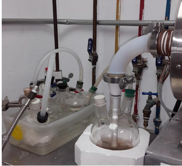
**Imagen 3. Trampa fría en la salida de equipo de spray pirolisis**
