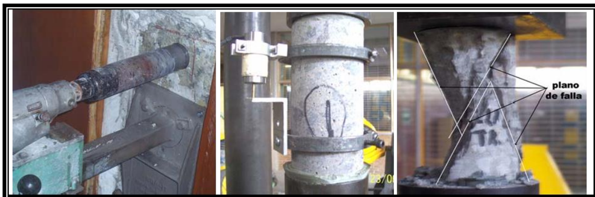
Figura.2.6.1. Extracción, preparación y prueba a compresión de corazón de concreto.(Bungey y Millard, 1996).
