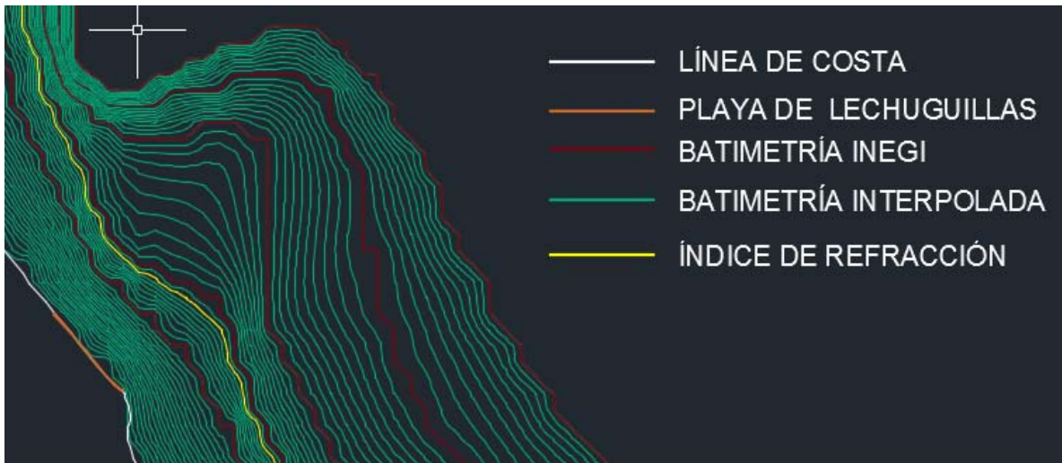
Figura 4.9: Batimetría extrapolada con base en datos batimétricos de INEGI. Fuente: Elaboración propia interpolando datos obtenidos de INEGI.
