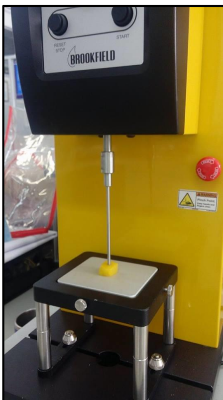
Figura 15. Prueba de firmeza a las muestras de mango fresco cortado.
