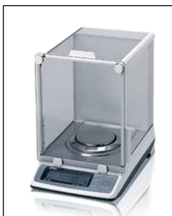
Figura 12. Balanza analítica AND modelo HR200
