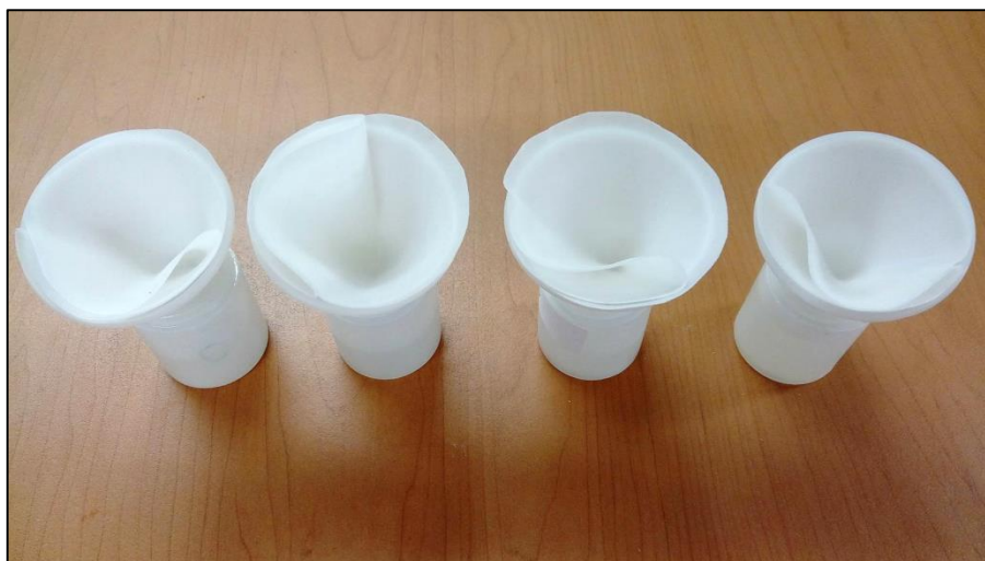
Figura 17. Recipientes de plástico de 60 ml con embudo y papel filtro para la separación del precipitado
