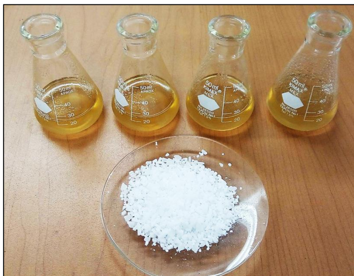
Figura 10. Solución de acetato de plomo y reactivo de NaOH
