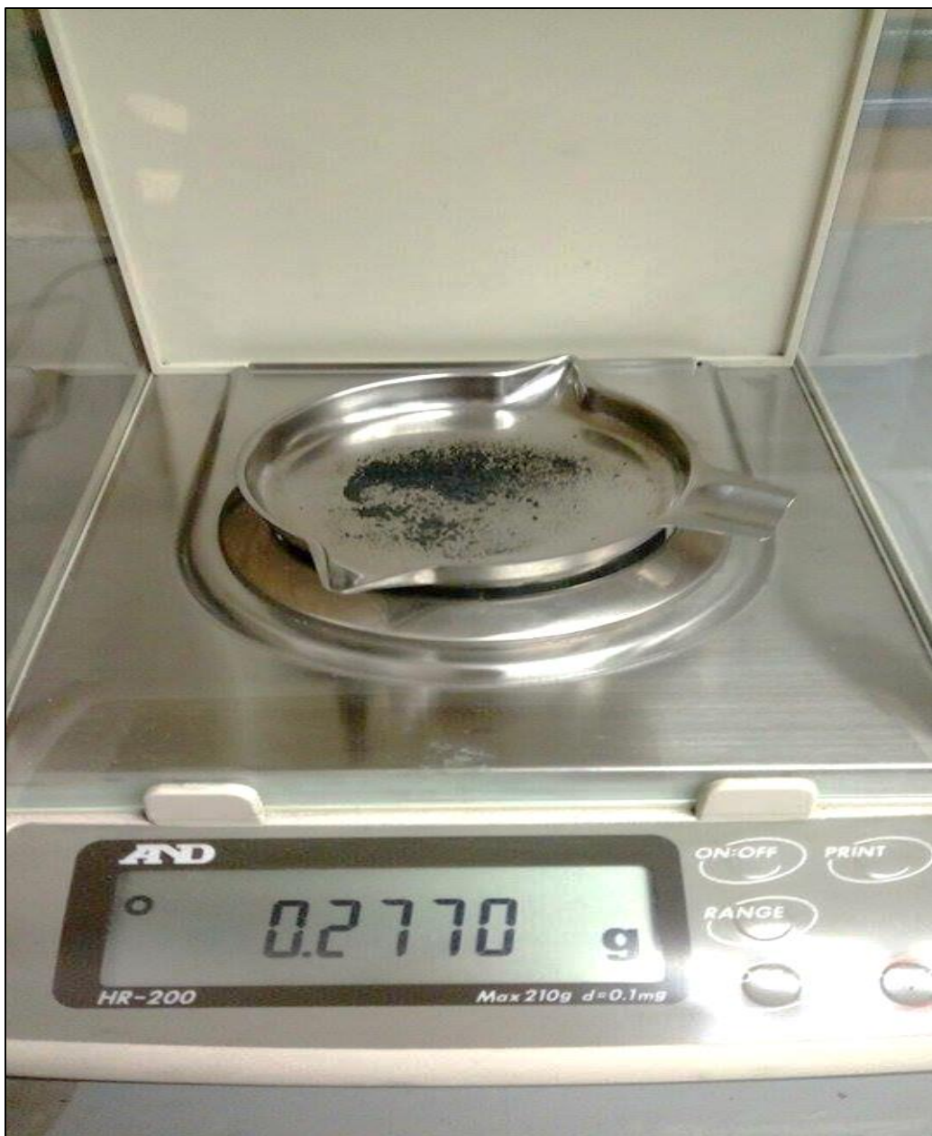
Figura 22. Plomo metálico recuperado
