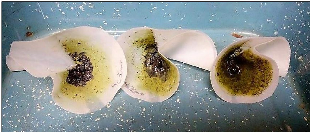
Figura 21. Cemento de plomo en papel filtro.
