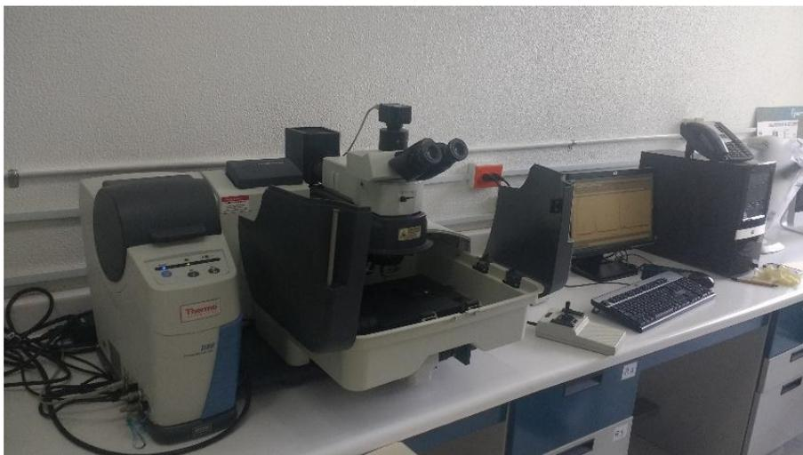
**Figura 16.** Espectroscopio micro Raman DRX Thermo Scientific del Laboratorio de Materiales Avanzados del Instituto de Física de la UNAM.
