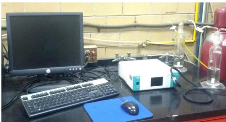
**Figura 19.** Potenciostato y Galvanostato uAutolab Tipo III del laboratorio 112 de la División de Estudios de Posgrado de la Facultad de Química, UNAM.
