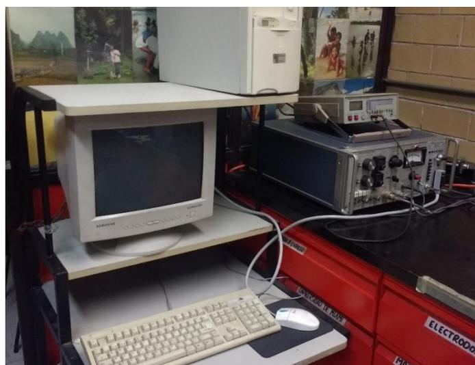
**Figura 15.** Potenciostato y Galvanostato EG&G Princeton Applied Research del laboratorio 112 de la División de Estudios de Posgrado de la Facultad de Química, UNAM.
